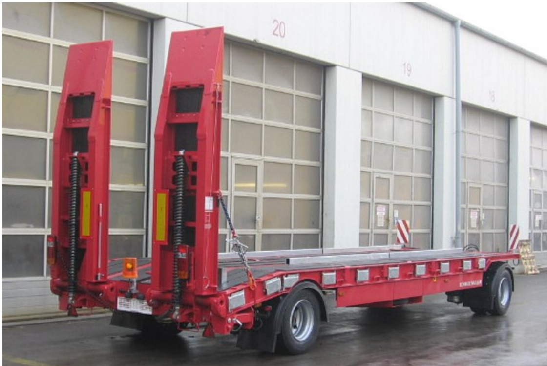
2-Achs-Tiefladeanhänger mit geradem Plateau
