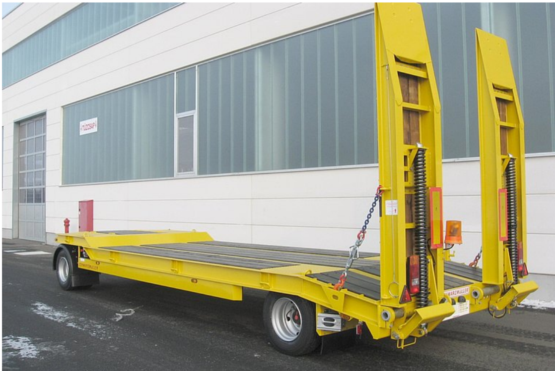
2-Achs-Tiefladeanhänger mit gekröpftem Plateau
