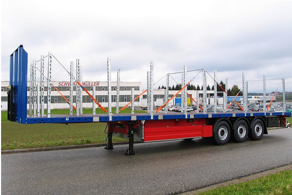
3-Achs-Plateausattelanhänger für Baustahlmatten-Transporte
