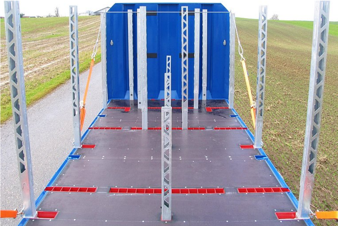
Steckgehäusepositionen für Ladungssicherung der Baustahlmattenstapel mit je 6.000 mm Länge
