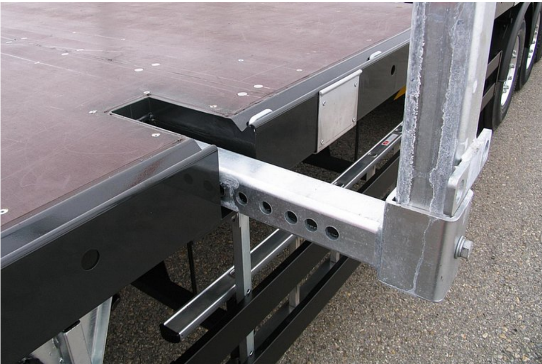
Ausziehbare Leichtbau-Formrohr-Begrenzungen, 13-fach verstellbar für eine Ladebreite von 2.000 bis 3.100 mm
