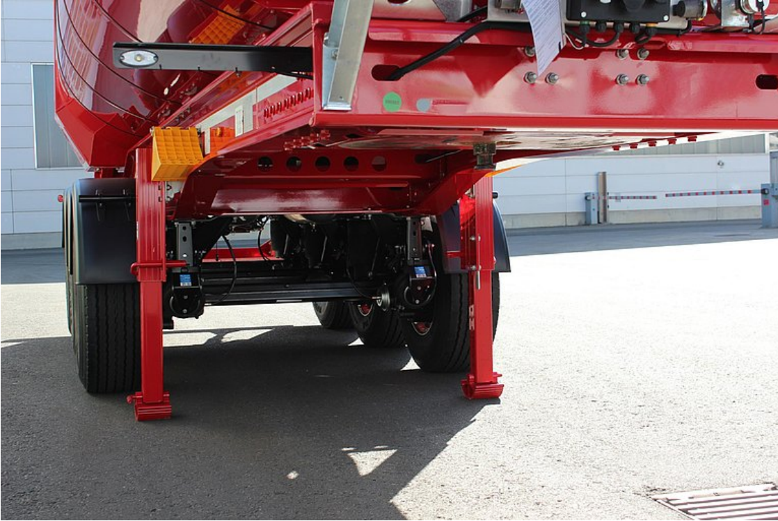
Stabile und verwindungssteife Aluminium-Fahrgestellkonstruktion mit zusätzlichen Torsionsrohren für eine hohe Kippstabilität
