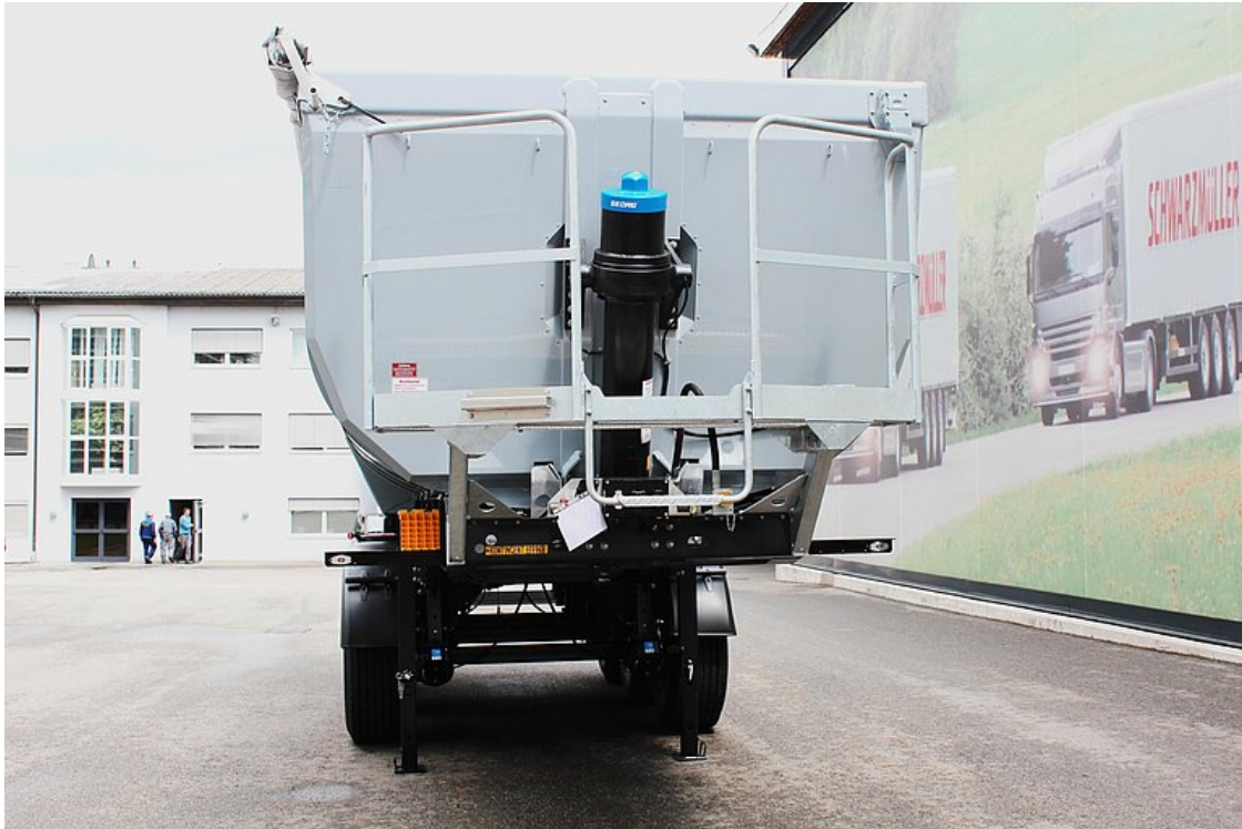
Isolierte Vorderwand mit hartverchromtem, qualitativ hochwertigem Frontkipppylinder
