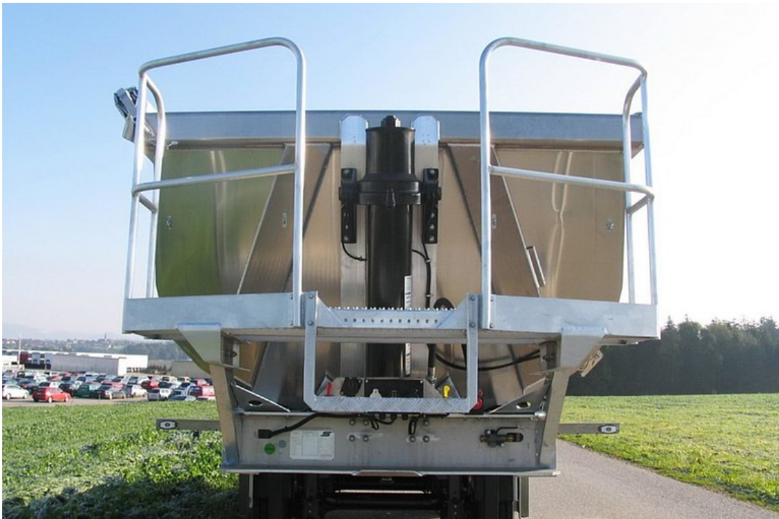
Schräge Vorderwand mit hartverchromtem, qualitativ hochwertigem Frontkippzylinder
