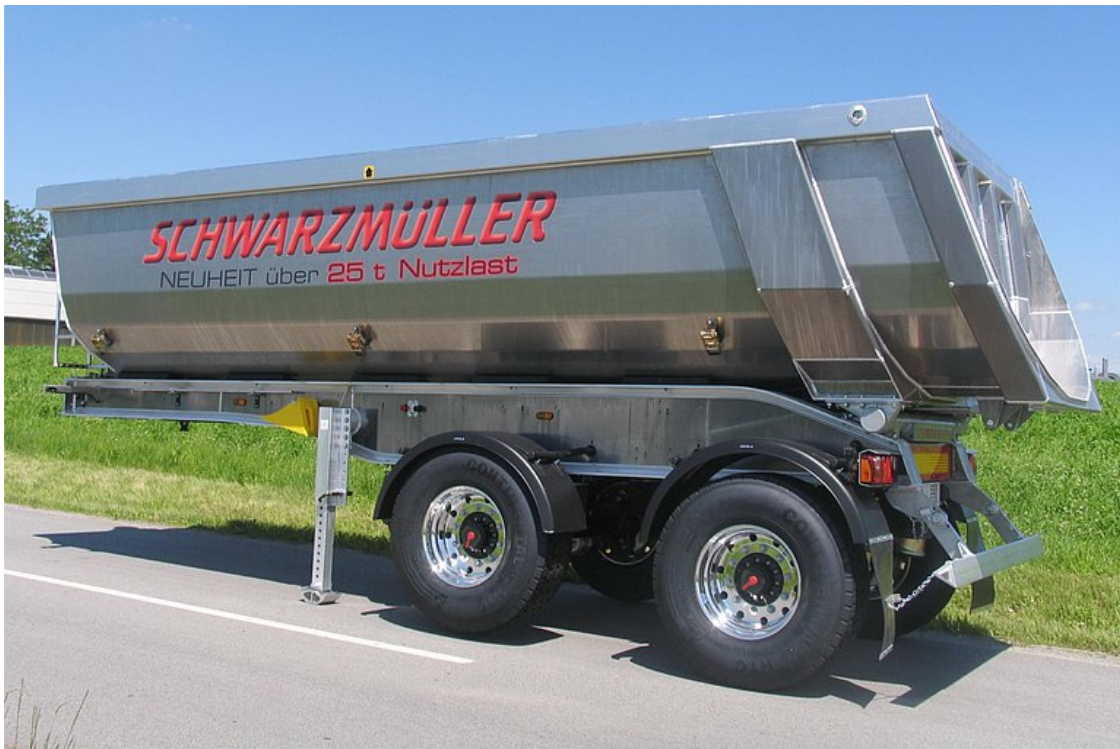
2-Achs-Vollaluminium-Segmentmulden-Kippsattelanhänger - Radstand 1.810 mm
