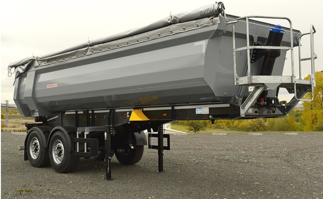
Bestmöglicher Stoß- und Verschleißschutz durch speziell gekantete Hardox-Mulde
