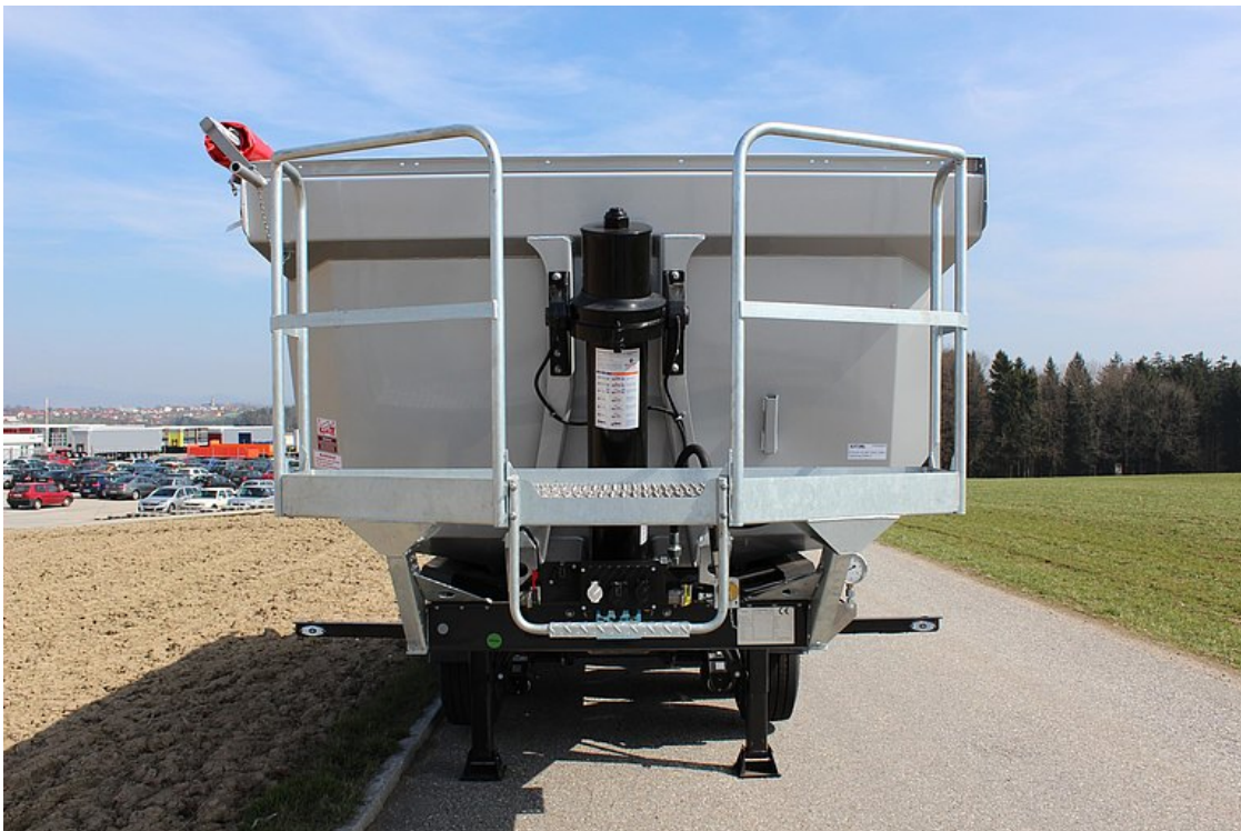
Stehpodest an der Vorderwand zur Bedienung der Rollplane
