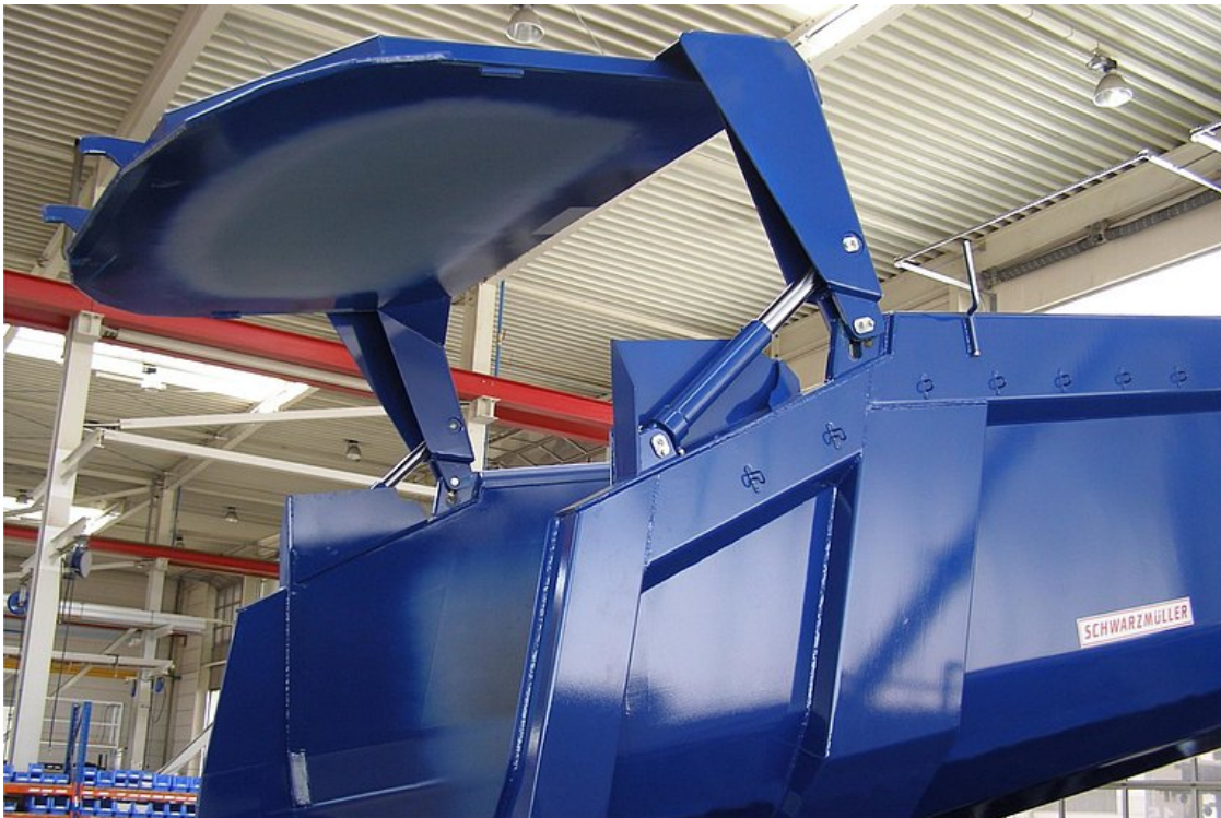
OPTIONAL: Sonder-Pendelrückwand für extrahohe Öffnung mit versenkter Lagerung und automatische Hydraulikbetätigung
