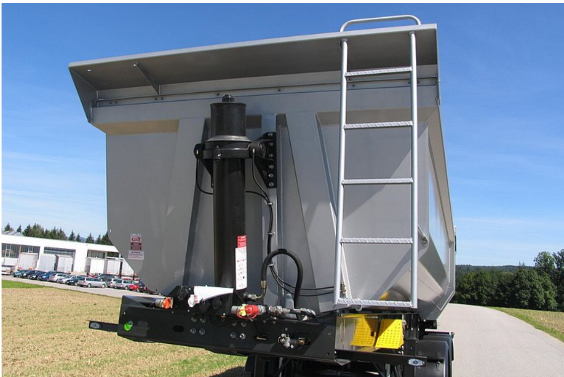
Optimale Lastverteilung durch schräge Vorderwand
