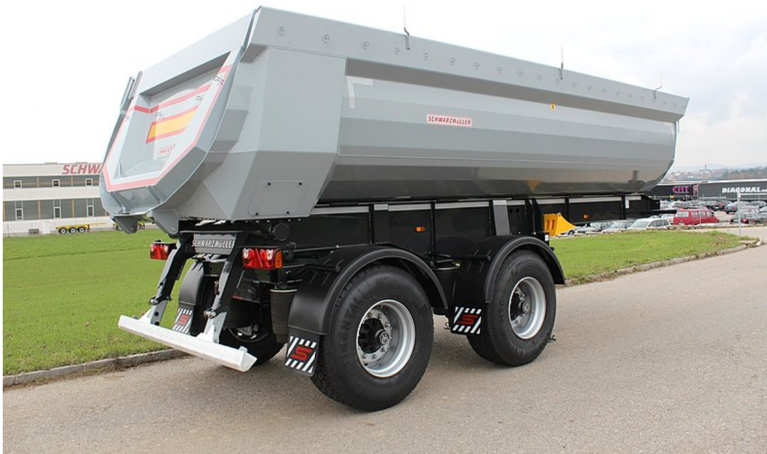
2-Achs-Stahl-Segmentmulden-Kippsattelanhänger - Radstand 1.810 mm
