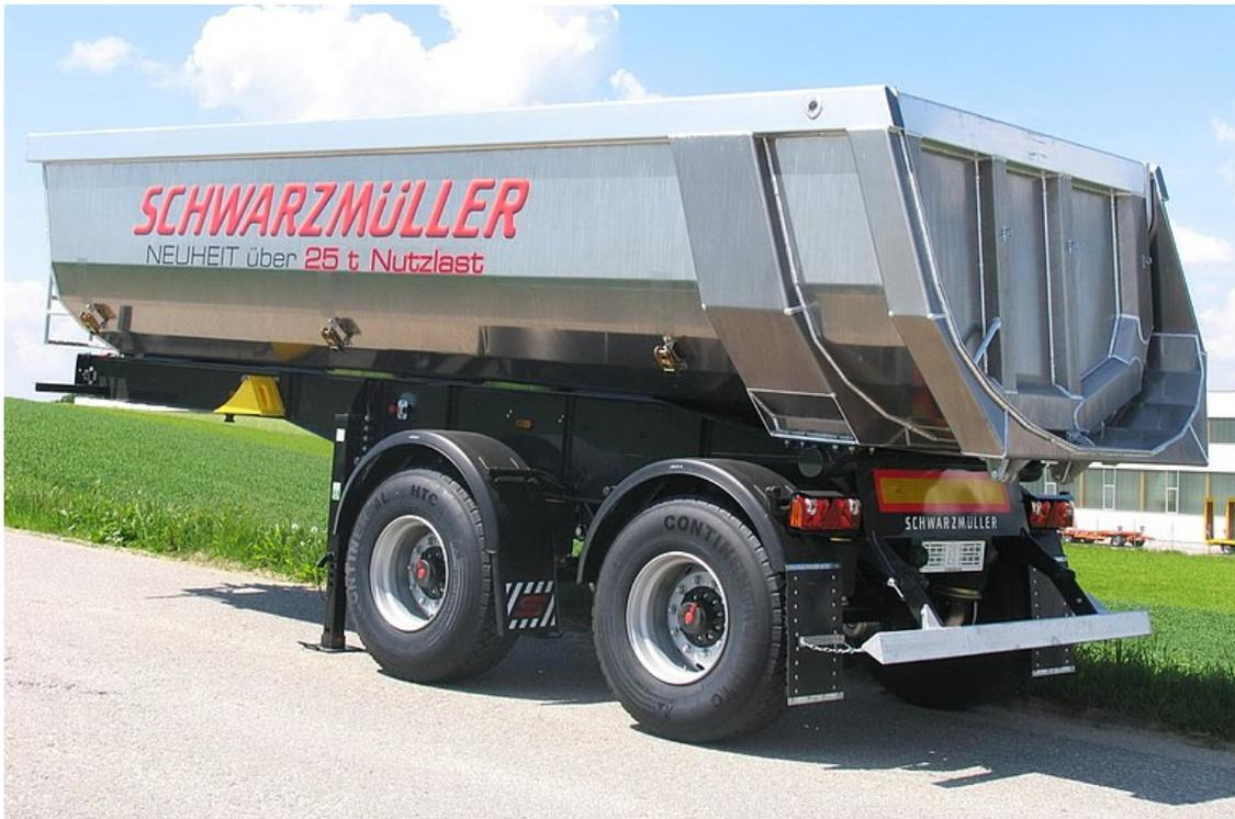
2-Achs-Aluminium-Segmentmulden-Kippsattelanhängen - Radstand 1.810 mm
