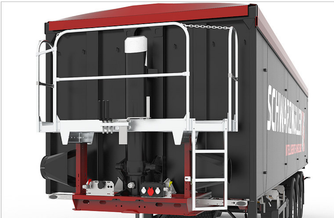
OPTIONAL: Stehpodest - Das Stehpodest dient dem Aufstieg zur Mulde, der Überwachung des Ladevorgangs sowie dem Öffnen und Schließen der Abdeckplane.
