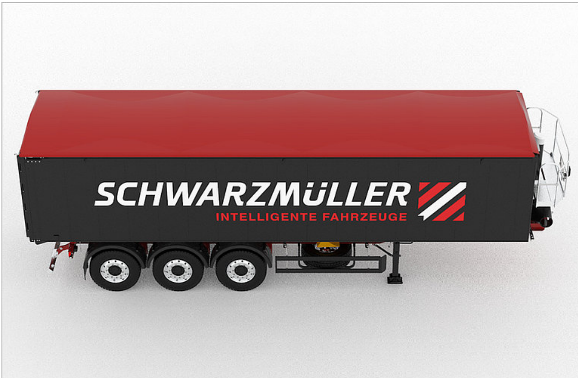
OPTIONAL: Rollplane - Eine aufrollbare Plane schützt Ladegut vor Wetter und Materialverlust. Das Auf- und Zurollen erfolgt vom Stehpodest aus, die Sicherung mittels Schnellspanner oder Gurten.
