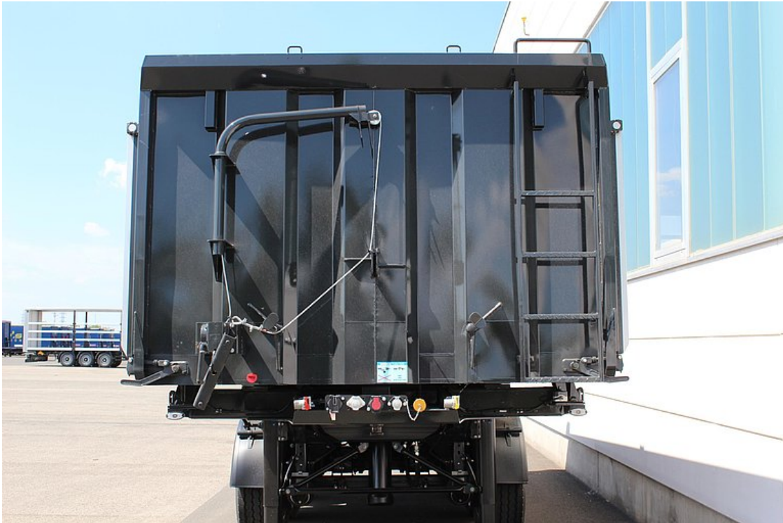
Fixe Stahlblech-Vorderwand mit Bindeösen, Aufstiegleiter und Haltebügeln
