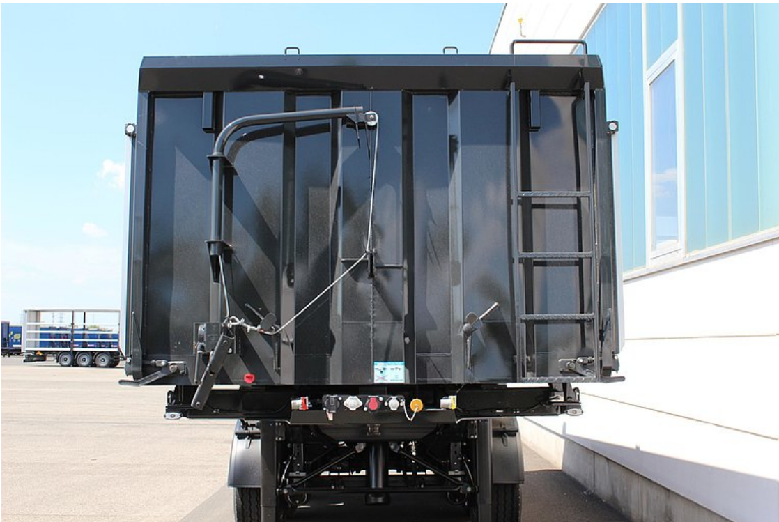
Fixe Stahlblech-Vorderwand mit Bindeösen, Aufstiegleiter und Haltebügeln
