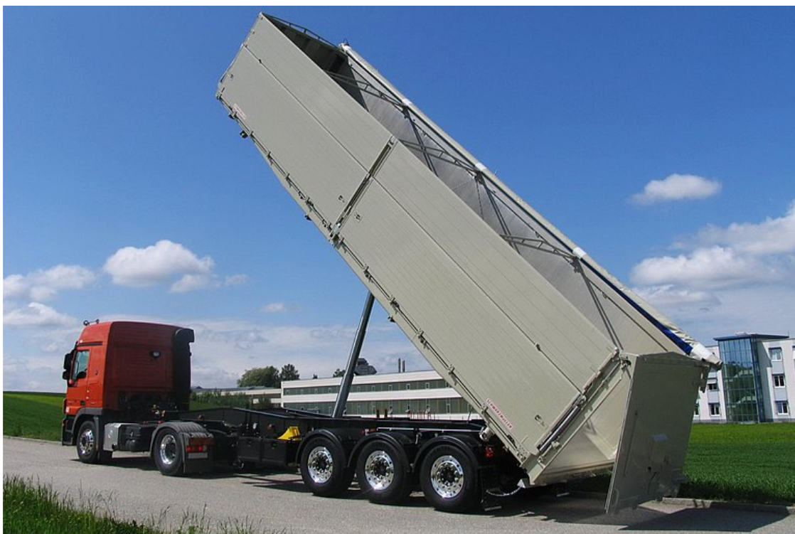
3-Achs-Großraum-Aluminium-Hohlprofilmulden-Kippsattelanhänger für Be- und Entladung sowie Kippung in FR links oder rückwärts
