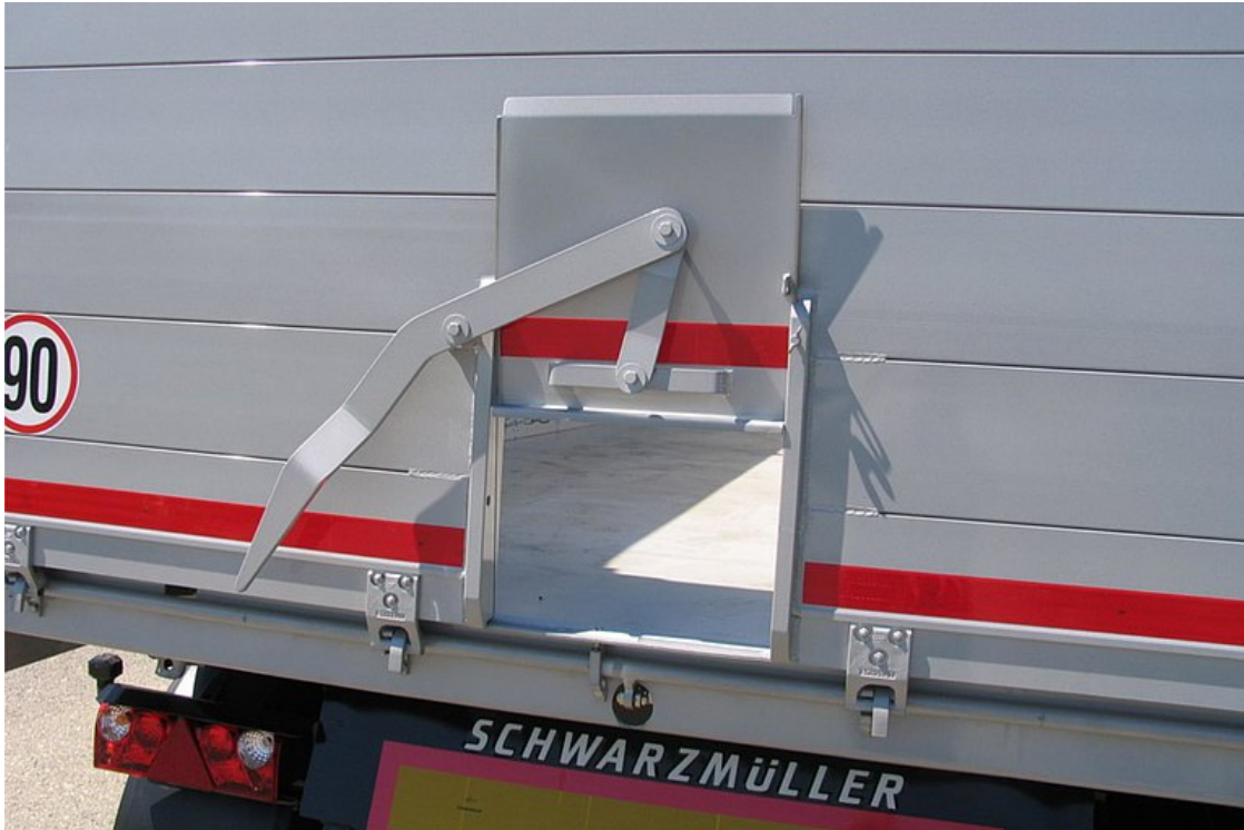
OPTIONAL: Getreideschuber ca. 400/400 mm mit seitl. Dosierhebel in Rückwand und Wasserschutzblech
