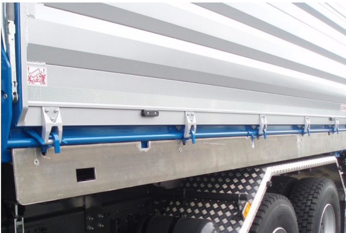
OPTIONAL: Aluminium-Klappe auf seitlicher Zentralverriegelungswelle
