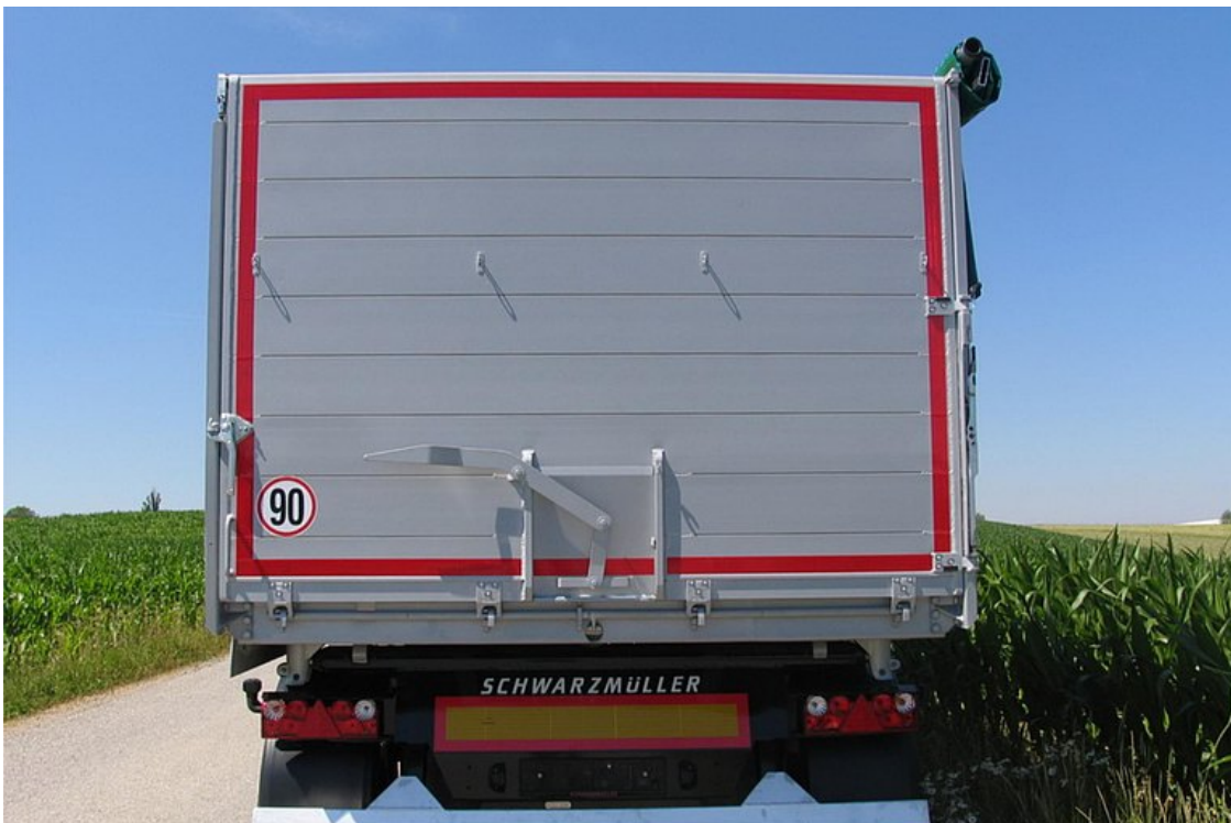
Aluminium-Hohlprofil-Rückwand, abklappbar und zusätzlich pendelbar mit man. Zentralverriegelung, sowie OPTIONAL als Türflügel ausschwenkbar
