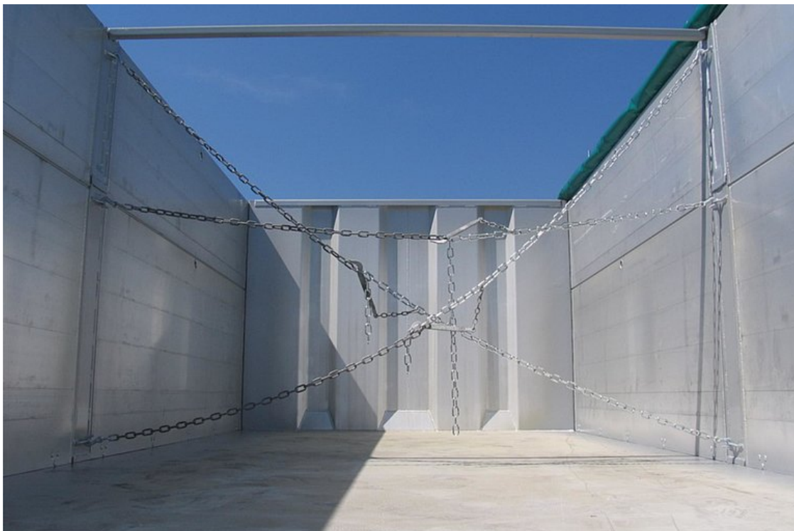
OPTIONAL: bei den Mittelsäulen und Aufsatzmittelsäulen jeweils mit Spannkette samt Schneller
