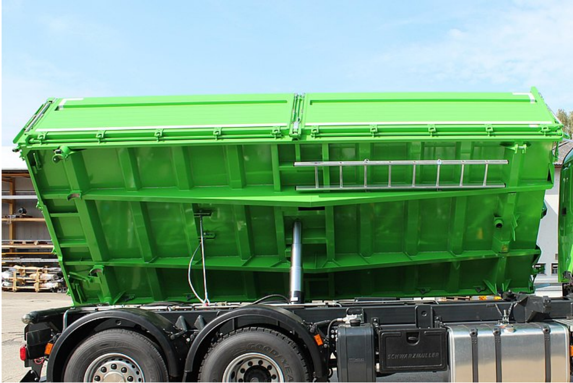
Konische Trapezprofil-Längsträger in hochfester Leichtbauweise mit kleinen Bodenfeldern für große Beulfestigkeit und hoher Stoßabfederung
