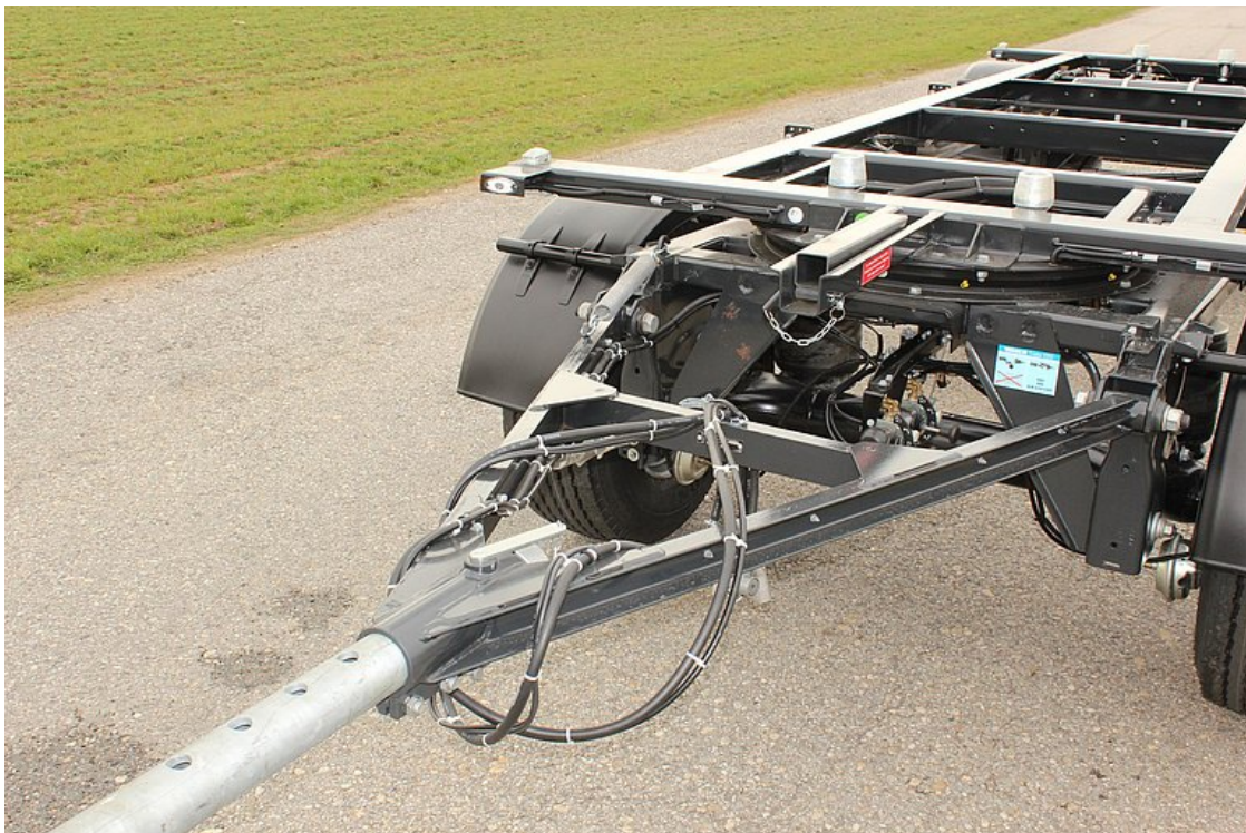
OPTIONAL: Ausziehbare Zuggabel, max. 600 mm verstellbar, mit Getofix-Deichselstütze
