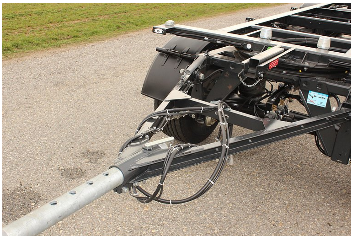
Ausziehbare Zuggabel, max. 600 mm verstellbar, mit Getofix-Deichselstütze
