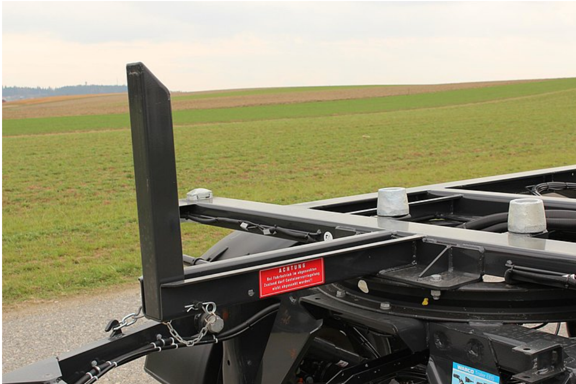
Anschlagstütze vorne umleg- und umsteckbar
