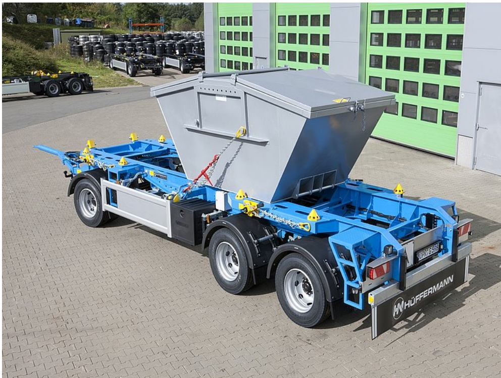
Vario Carrier zum Transport von einem Absetzbehälter im Nutzlastschwerpunkt
