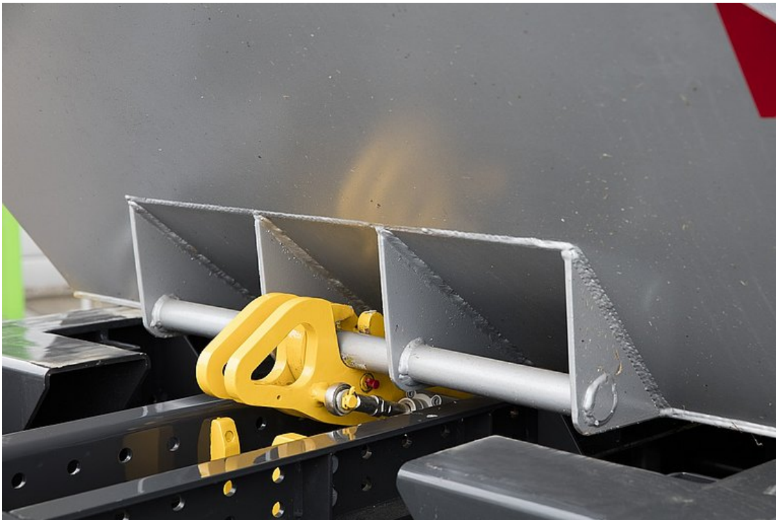
OPTIONAL: Kettenlose Ladungssicherung Multi-Fix
