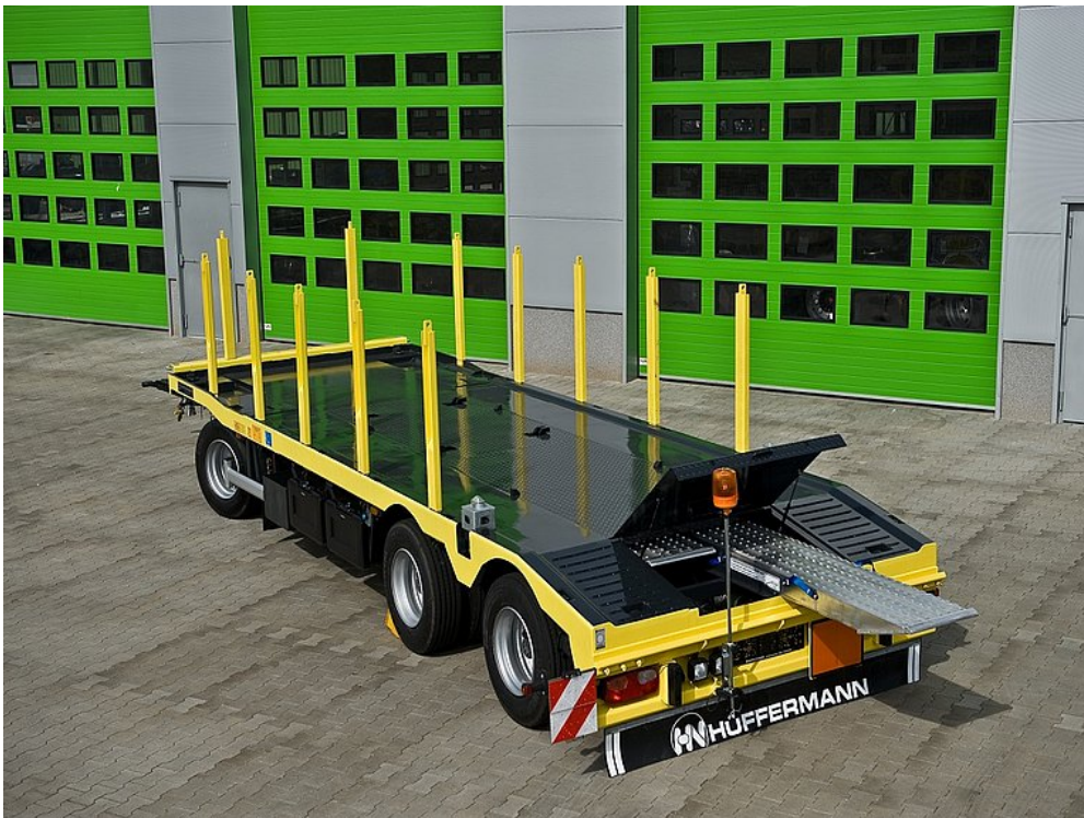
Sonderausstattung ISO-Container Aufnahme und Rungen, Sonderlackierung
