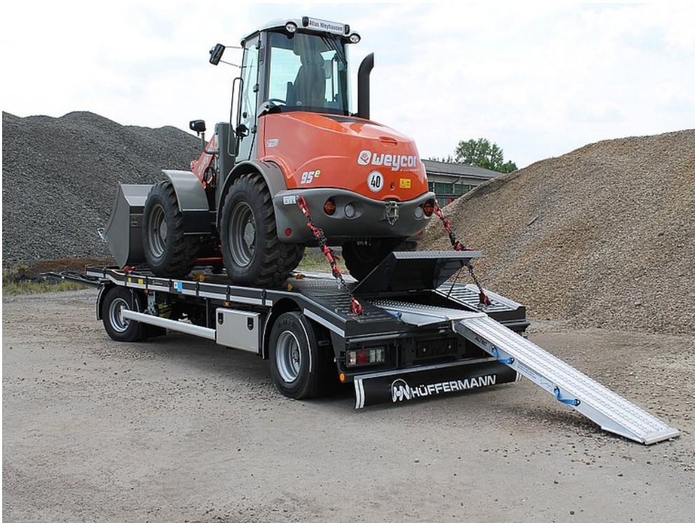
Verzurrung von Baumaschinen
