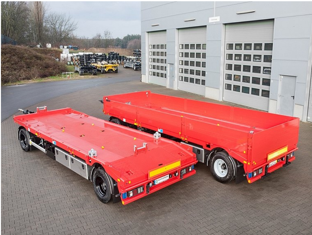
OPTIONAL: Links: ISO-Container Aufnahme, Seilwindenfenster. Rechts: Aluminiumbordwände
