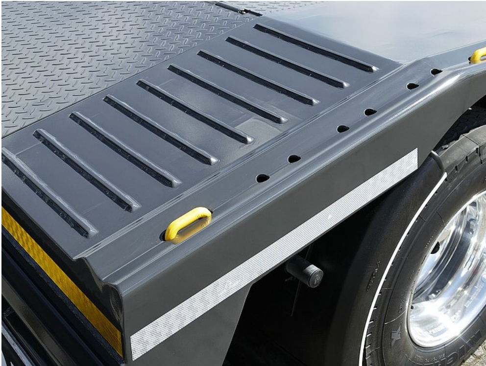
Versenkte und variabel umschaubare Zurrpunkte im Außenrahmen
