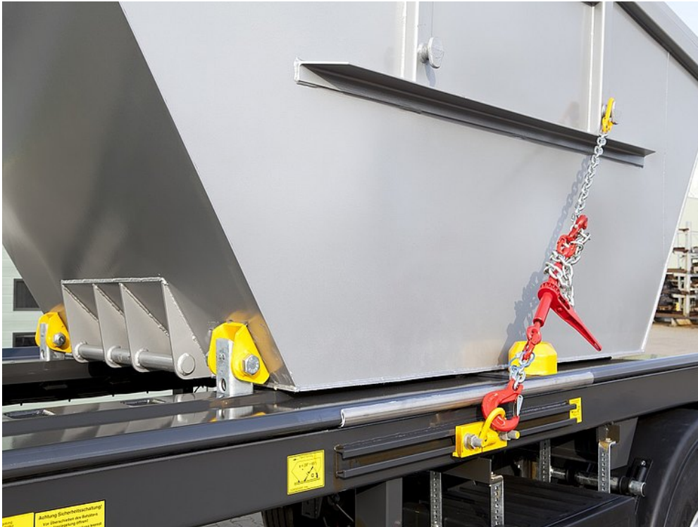
Kombinierte Ladungssicherung mit Zentrier-Fix und Zurrketten
