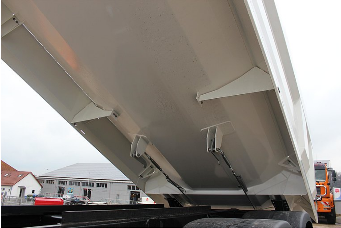
Bestmöglicher Stoß- und Verschleißschutz durch speziell gekantete Hardox-Mulde
