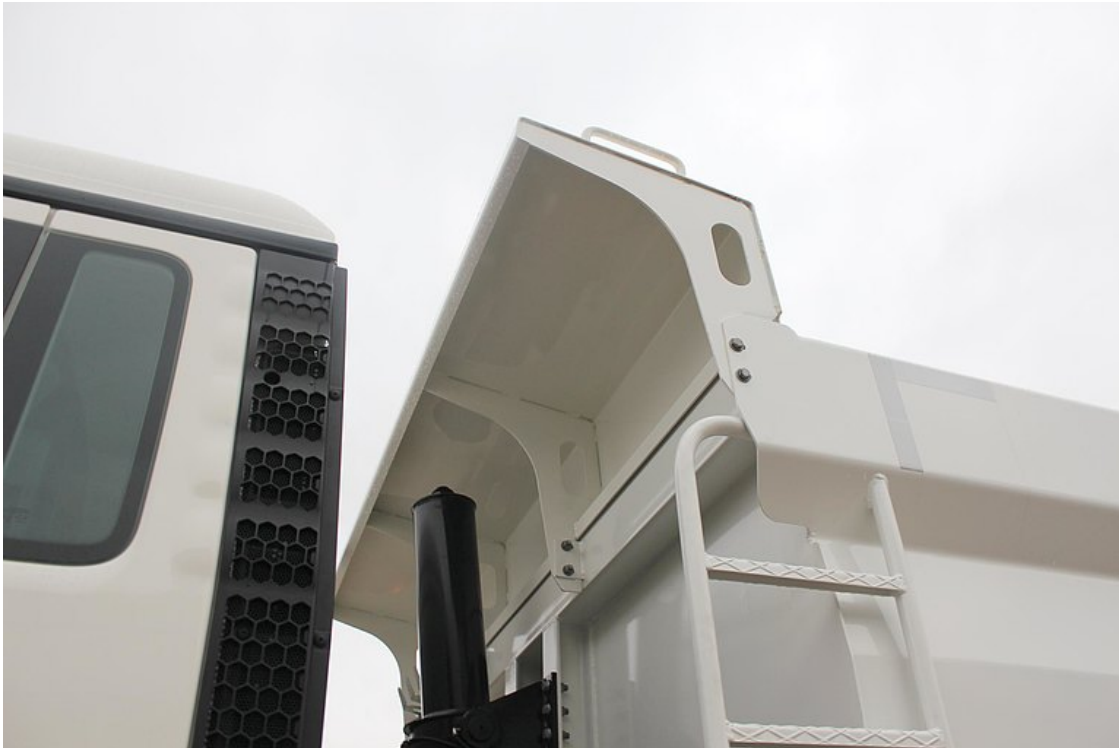
Vorderwand oben mit erhöhtem Baggerschutz
