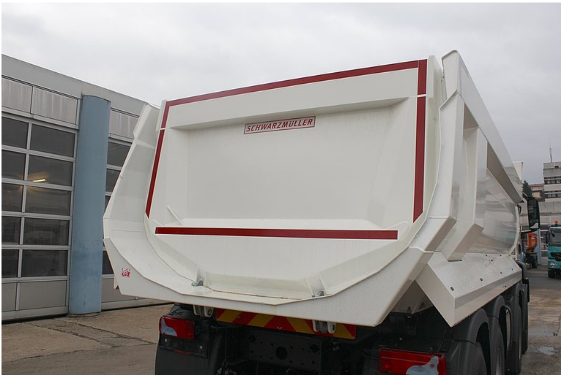
Stahlblech-Rückwand = Pendelwand mit versenkter Lagerung
