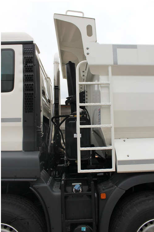
Linksseitig vorne außen fixe Aufstiegleiter
