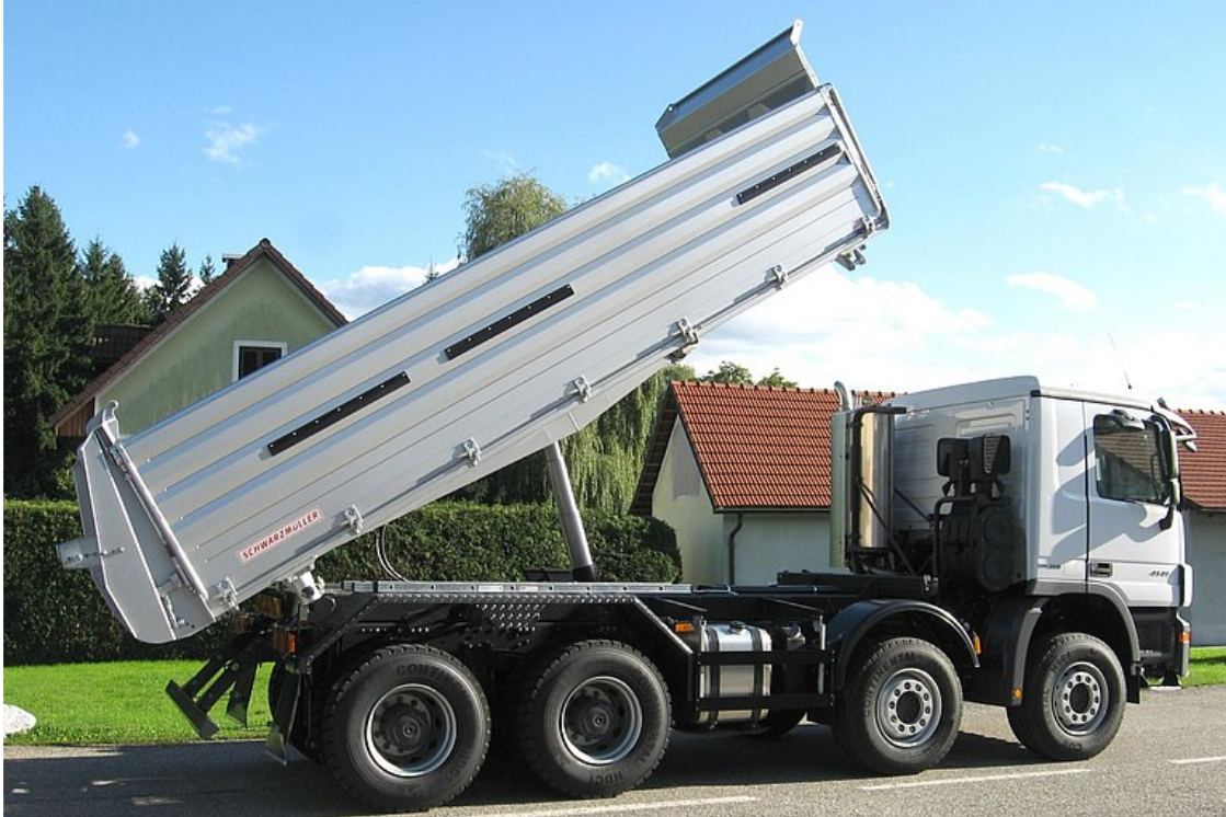
3-Seiten-Kippaufbau auf 4-Achs-LKW - Baustelle
