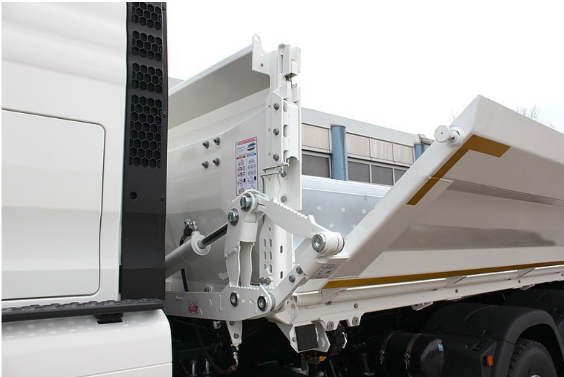
OPTIONAL: Linkseitig Bordmatic = hydraulisch abklappbare Seitenbordwand
