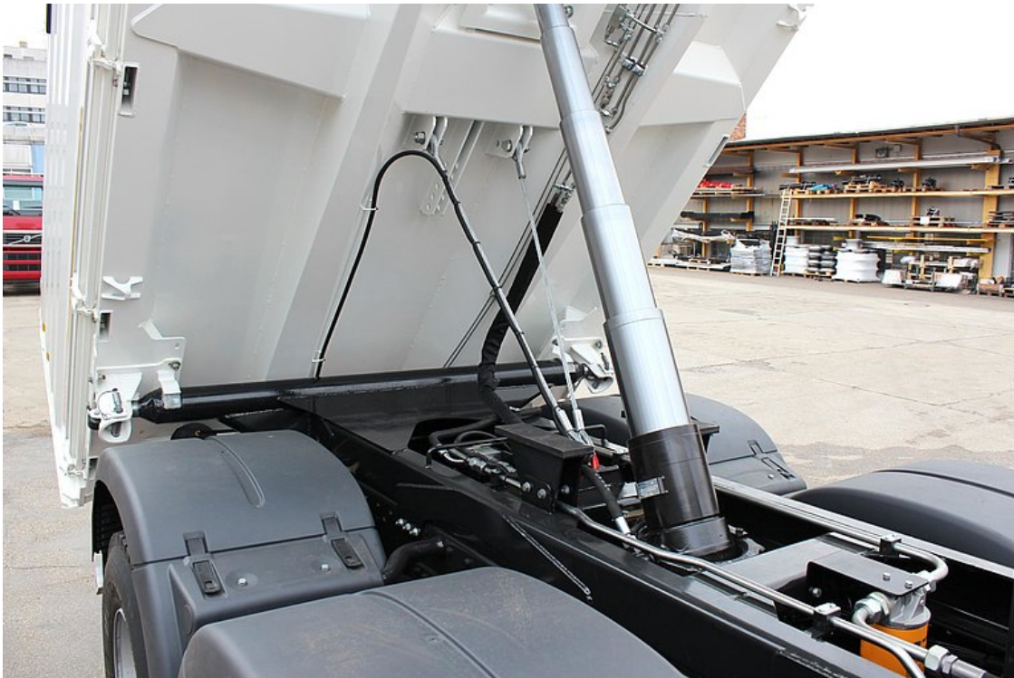
Hartverchromter, qualitativ hochwertiger Kippzylinder
