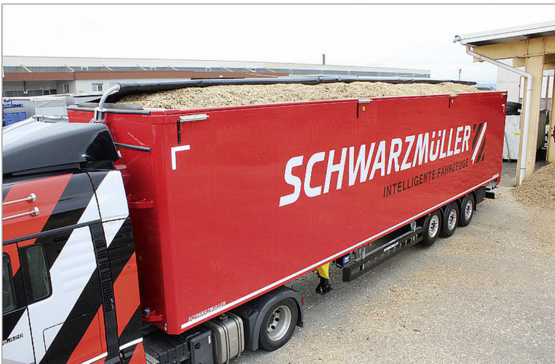
3-nápr. návěs s posuvnou podlahou a hliníkovým rámem - volitelně s elektricky posuvnou střechou
