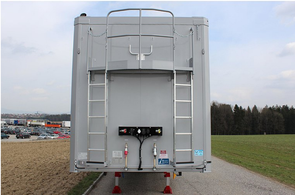
Přední stěna z dutých hliníkových profilů s vrchním stabilizačním rámem
