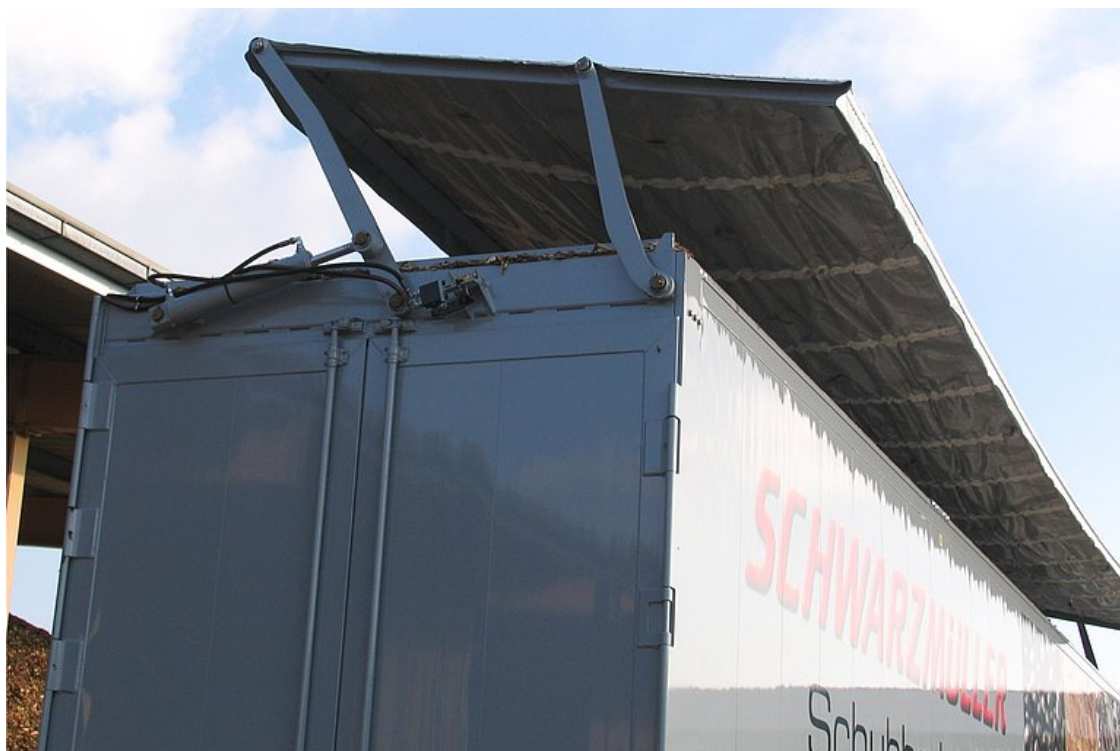
VOLITELNĚ: hydraulicky odklápěná střecha se střešním rámem a umělohmotnou plachtou
