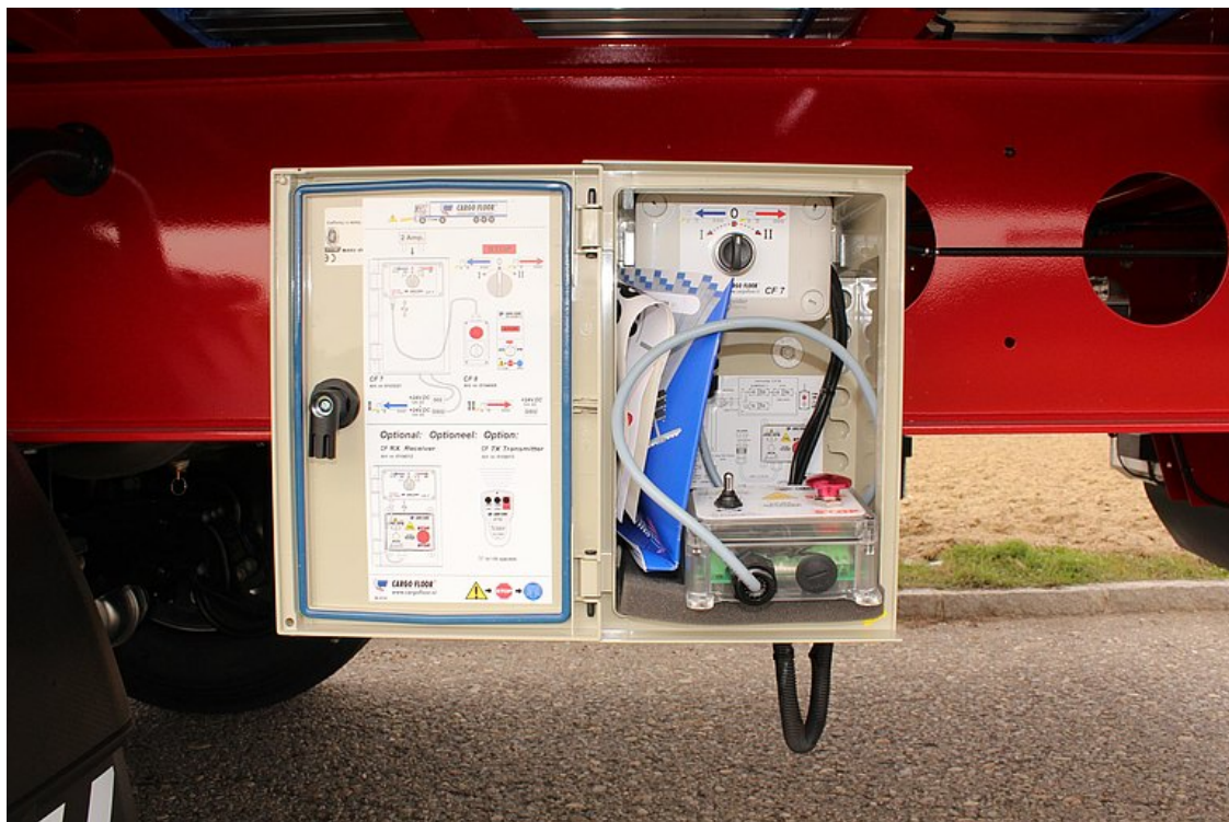
Ovládací jednotka posuvné podlahy ve vodotěsné schránce, rovněž s dodatečným dálkovým ovládáním s 10 m kabelem
