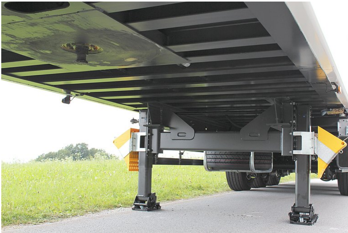
Hliníkový rám odlehčené konstrukce = úspora hmotnosti až 500 kg
