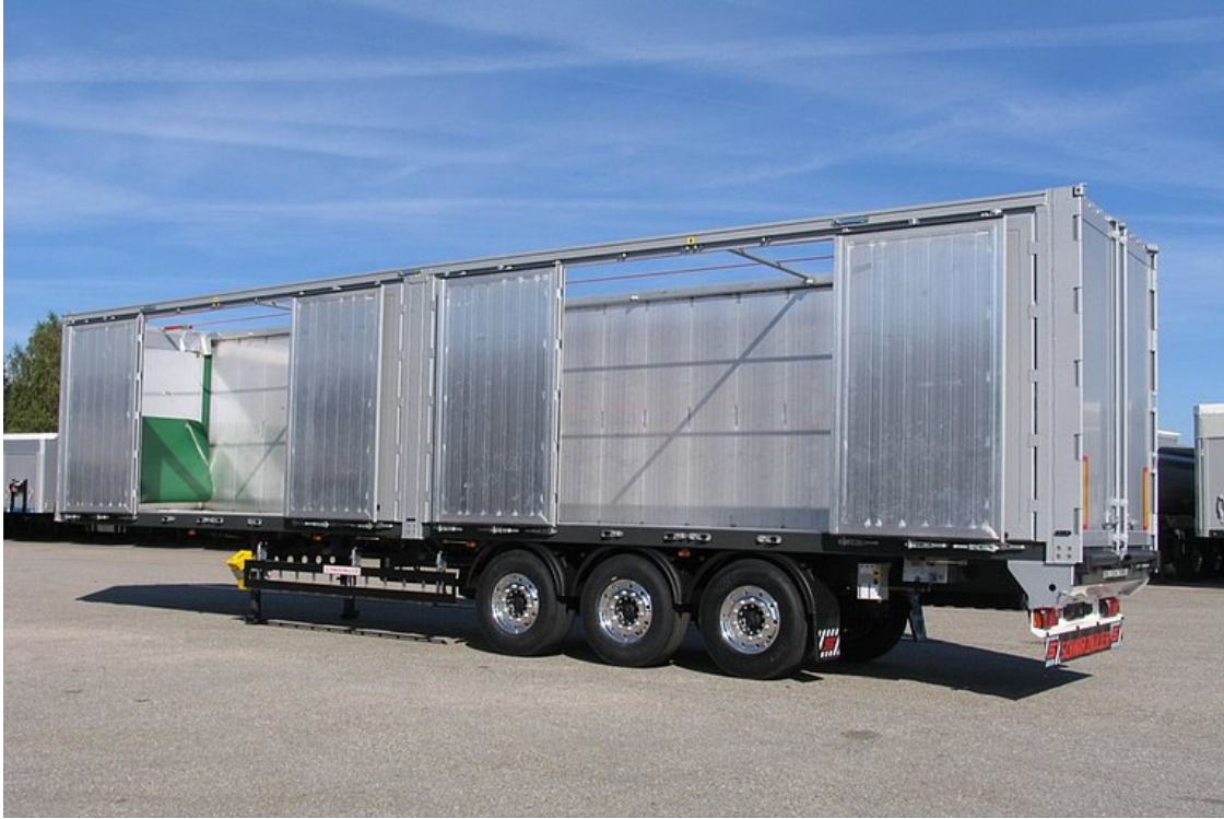
Na levé straně se dvěma 4-křídlymi vraty pro boční nakládku a vykládku
