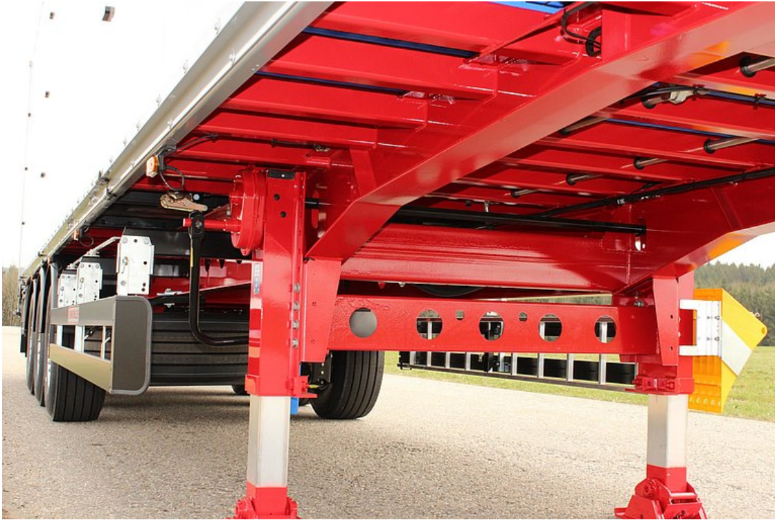
Tuhá ocelová konstrukce rámu
