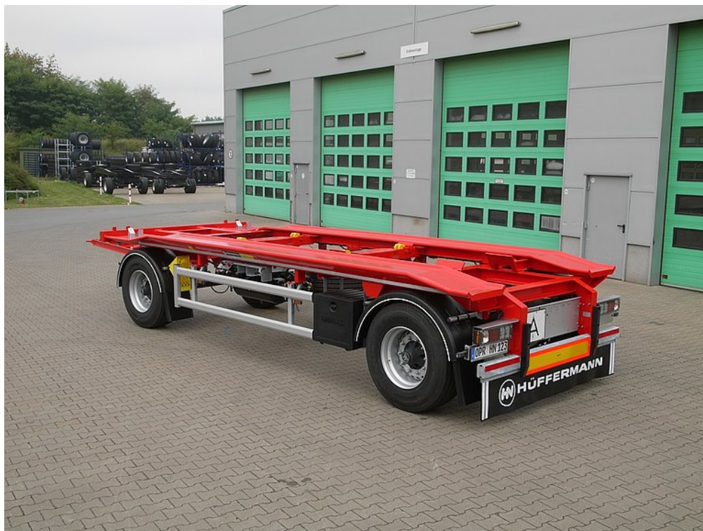
Zvláštní provedení, rozšíření jezdvové plochy, vnitřní a vnější centrování
