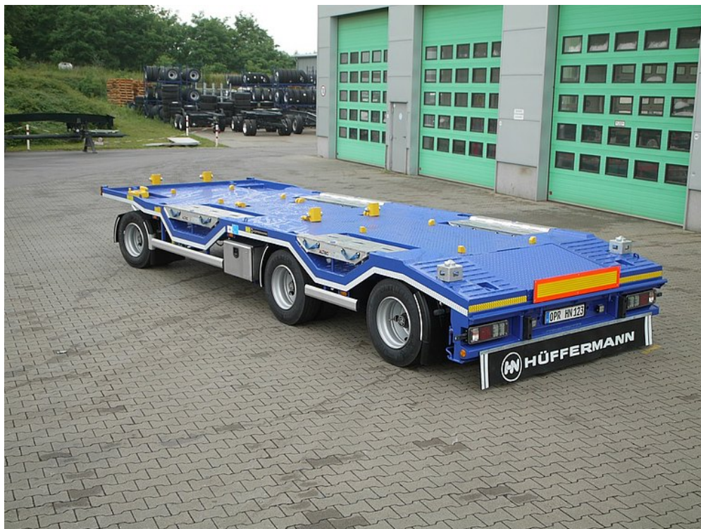
Zvláštní výbava prohlubně pro kola, výbava pro ISO kontejnery a odstavné kontejnery
