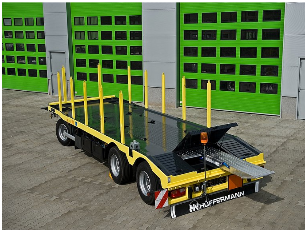
Zvláštní výbava uchycení ISO kontejnerů a klanic, speciální lakování
