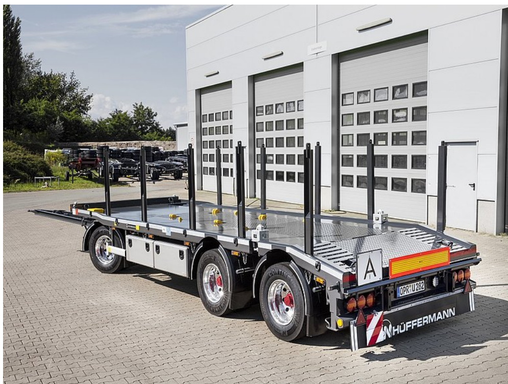
Zvláštní výbava uchycení ISO kontejnerů, klanice, hliníková kola a 3 LED kruhová světla
