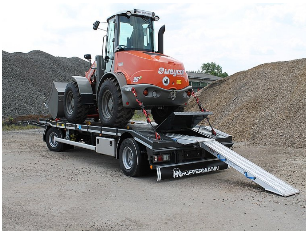
Ukotvení stavebních strojů
