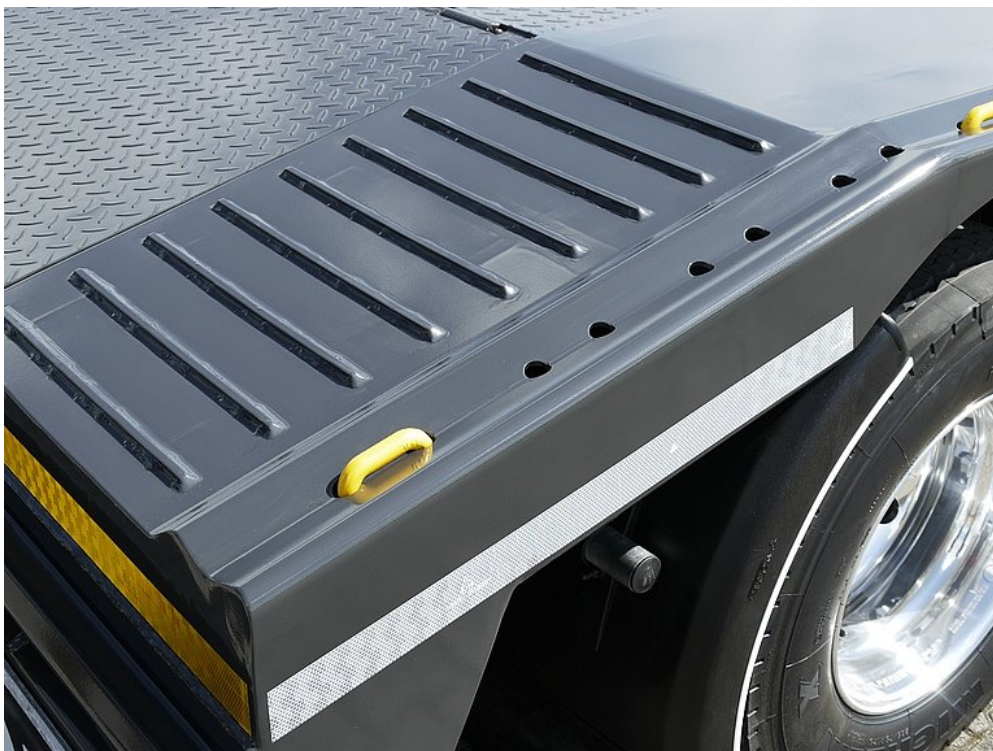
Zapuštěné a variabilně šroubovací přívazovací body ve vnějším rámu
