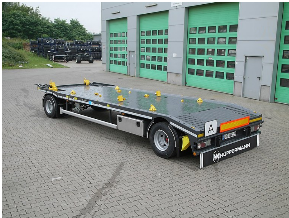
Vnější rám se zapuštěnými přivazovacími body a výbava pro sklápěč odstavných kontejnerů
