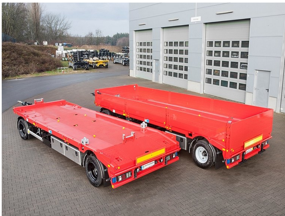
DOPLŇKOVÉ VYBAVENÍ: Vlevo: Uchycení pro ISO kontejnery, okno pro lanový naviják, vpravo: Hliníkové bočnice
