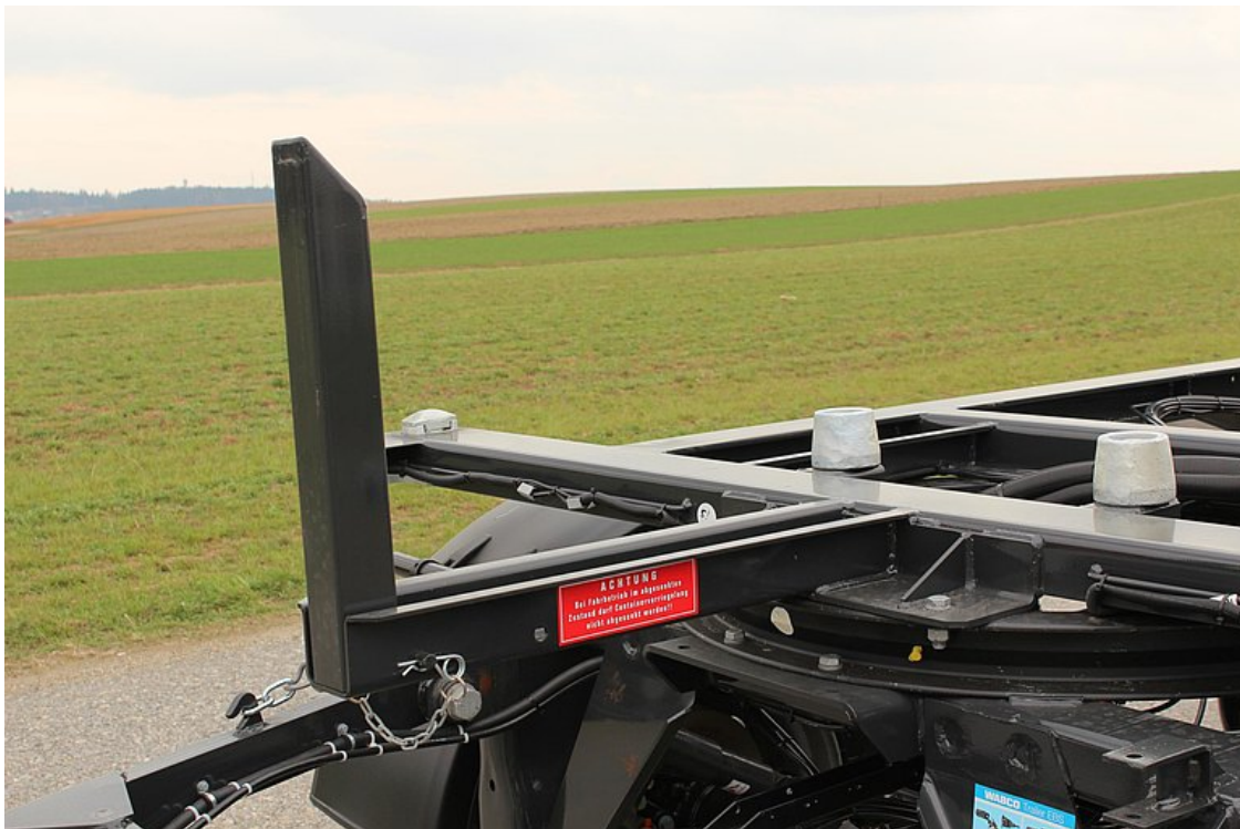
Vpředu přestavitelná dorazová opěra
