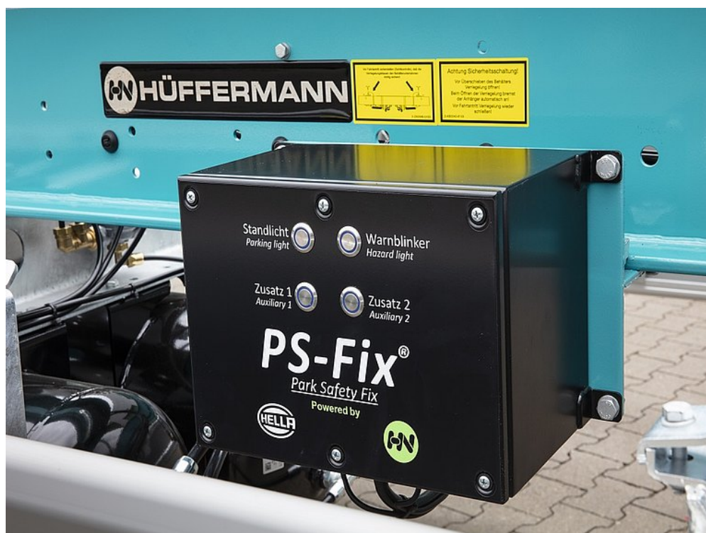
DOPLŇKOVÉ VYBAVENÍ: Nezávislý systém parkovacích světel pro větší bezpečnost. PS-Fix má čtyři funkce: parkovací světlo, funkce výstražného blikání, přidavné osvětlení a bleskové světlo
