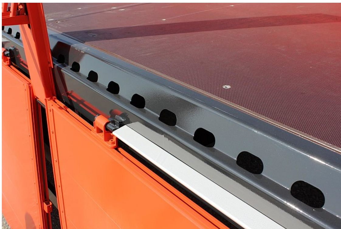
VOLITELNĚ: Děrovaný vnější rám s roztečí otvorů po cca 100 mm, otvory o rozměru 50/30, pro kotvení nákladu - 2 t
