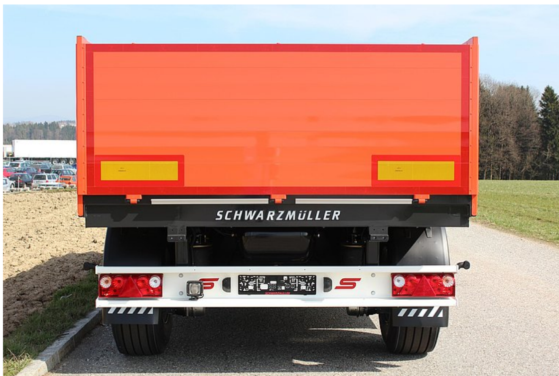
Sklopná zadní stěna z dutých hliníkových profilů, sklopné s KINNEGRIP dvojítm uzávěrem
