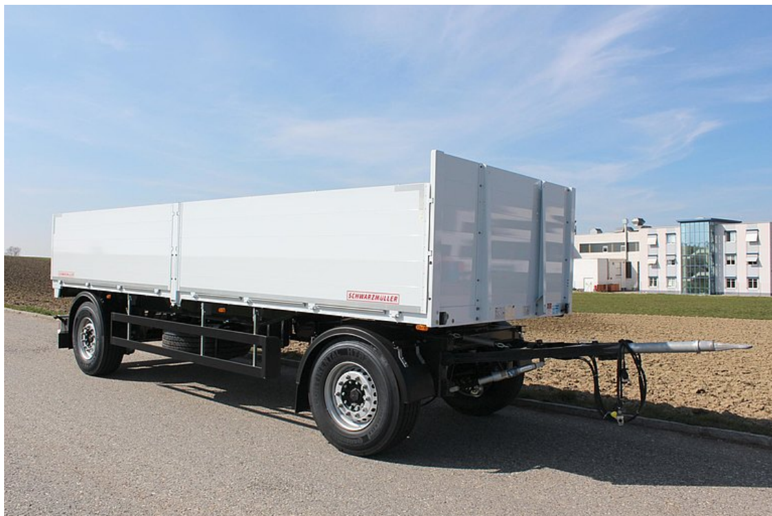
2-nápravový valníkový přívěs - stavební provedení
