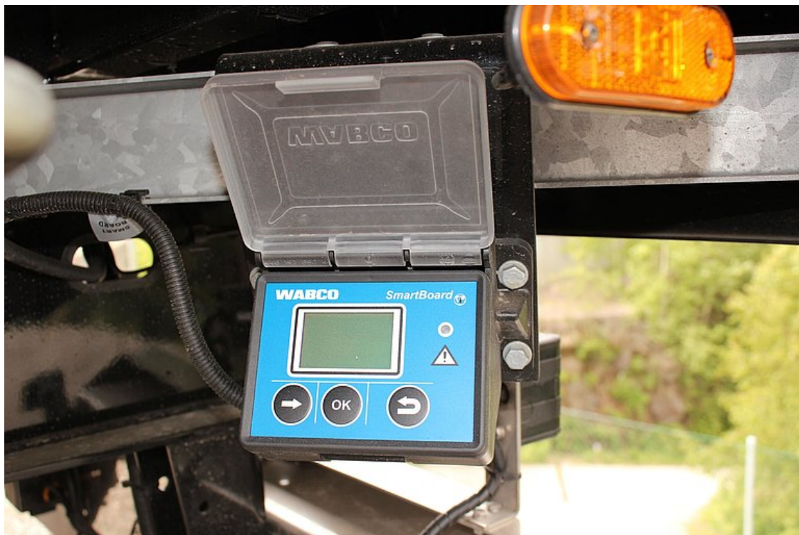
VOLITELNĚ: SmartBoard firmy Wabco - zobrazení dat o vozidle prostřednictvím displeje (stav kilometrů, zatížení náprav, diagnóza brzd, atd.)
