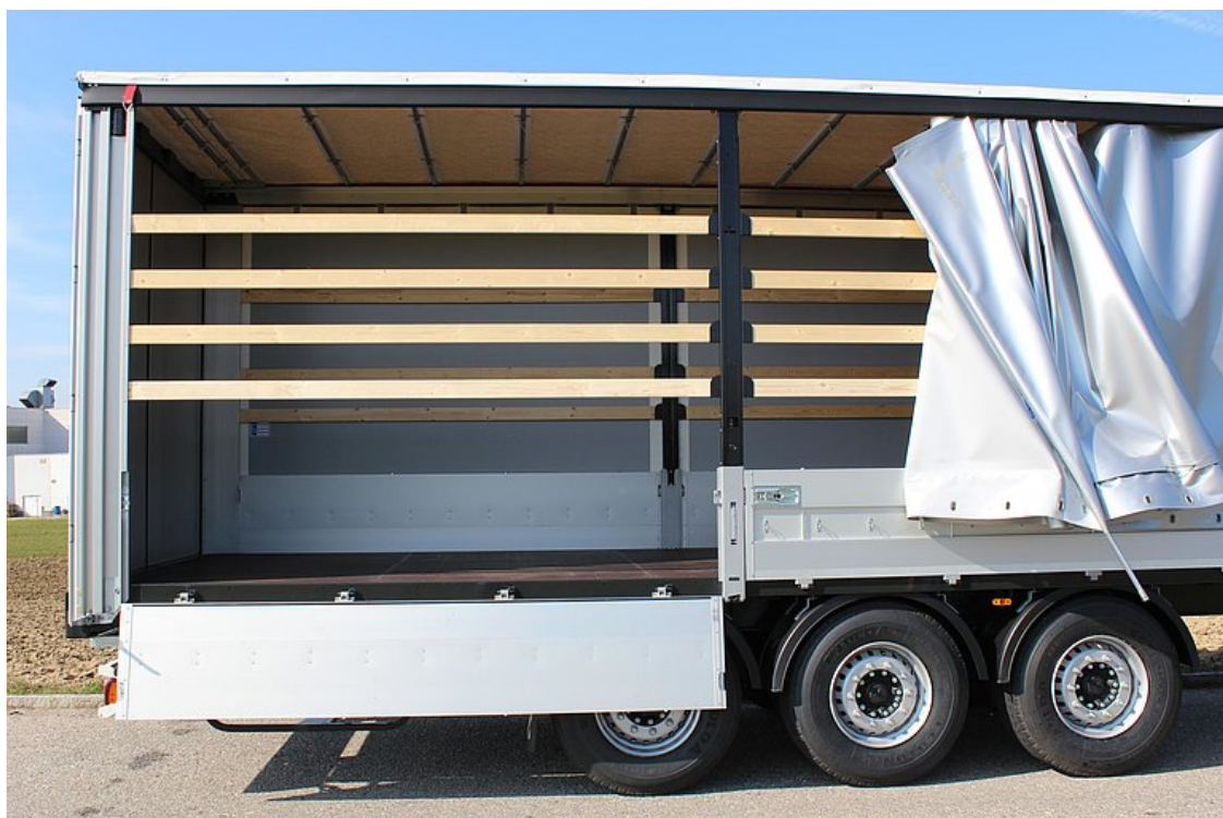
VOLITELNĚ: provedení s posuvnou plachtou a bočnicemi
