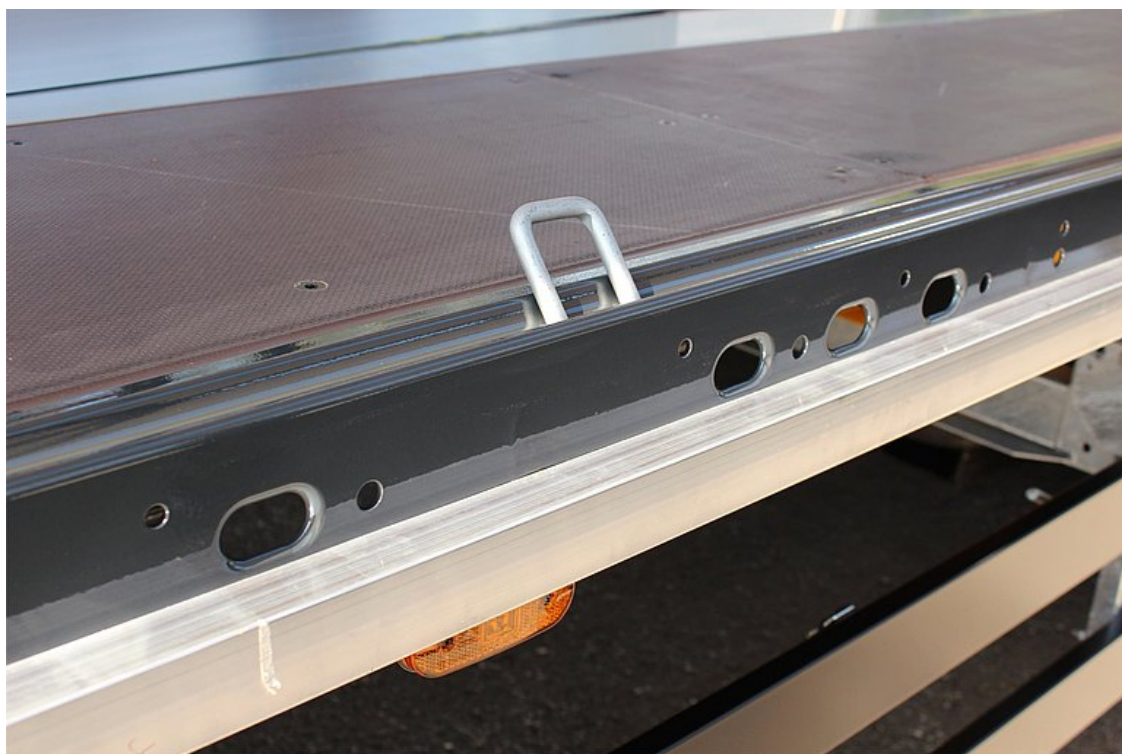
Děrovaný vnější rám s rozstupem děr cca 100 mm, podélné díry 40/25 mm dle DIN EN 12640 a 23 párů zapuštěných 2,5 t kotevních třmenů
