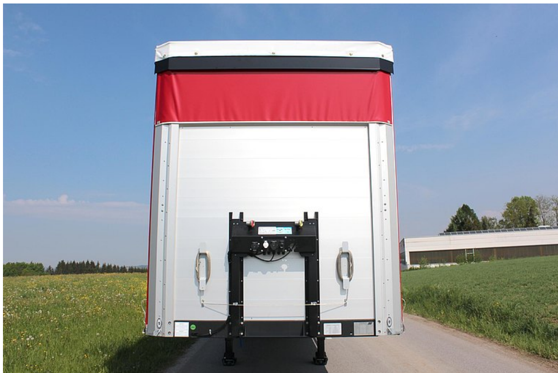
Zesílená přední stěna z dutých hliníkových profilů s integrovanými držáky napájecích přípojků
