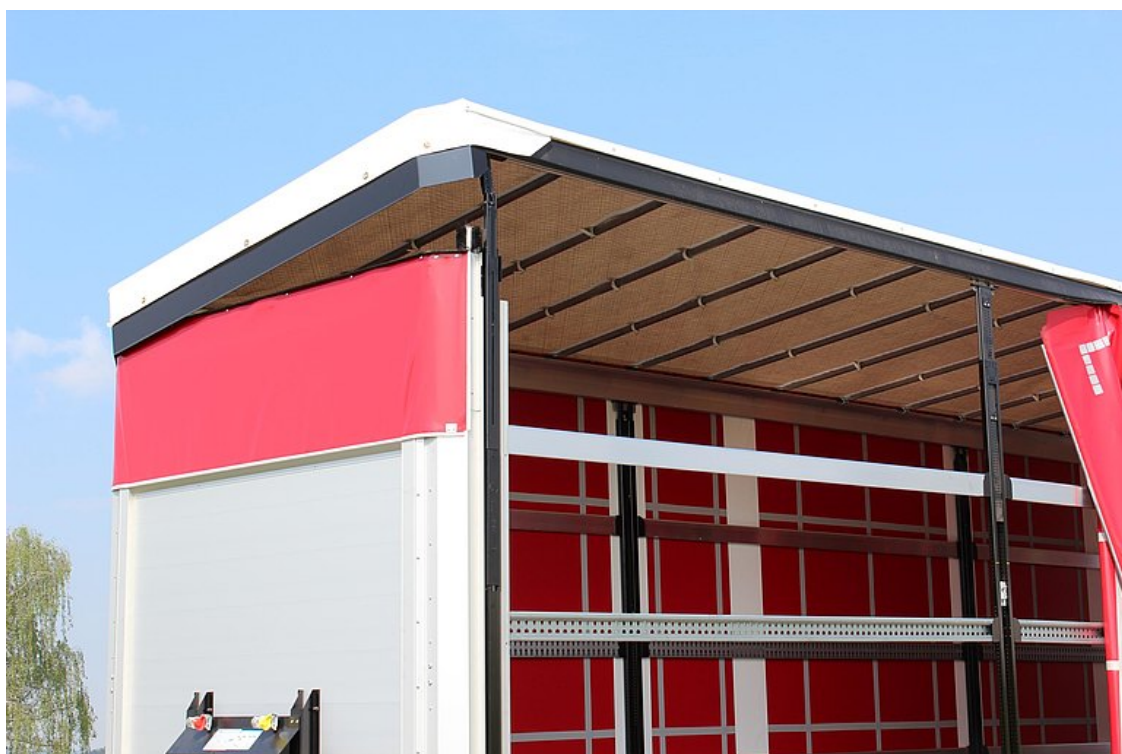
VOLITELNĚ: ruční hydraulický hubdach (zdvihání střechy) 400 mm pro rychlou nakládku a vykládku
