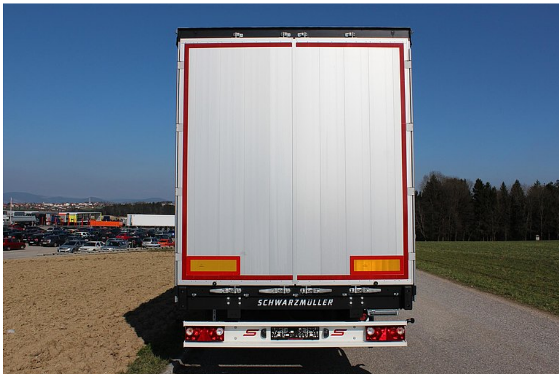
Vzadu našroubovaný portál s hliníkovými rohovými sloupky, dvoukřídlá vrata profilované konstrukce přes celou vnitřní šířku a výšku
