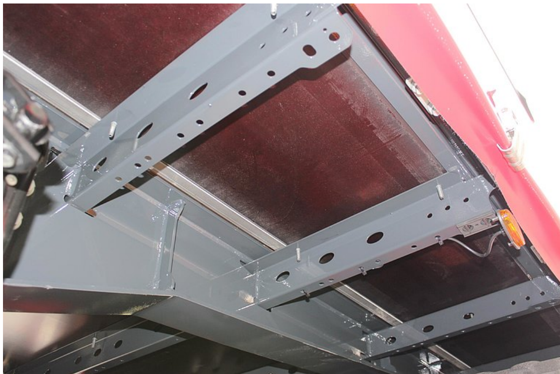
Podlaha z překližky o tl. 27 mm, zároveň s vnějším rámem, a se 2 profilovanými ocelovými kolejnicemi nad podélníky (zatížení podlahy do 7 t)
