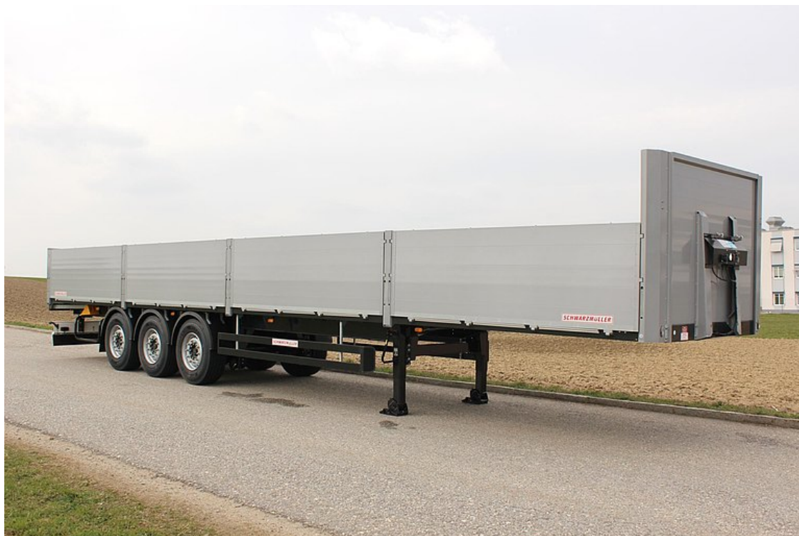
Zesílené provedení nástavby dle nakládacího certifikátu DIN EN 12642 kód XL
