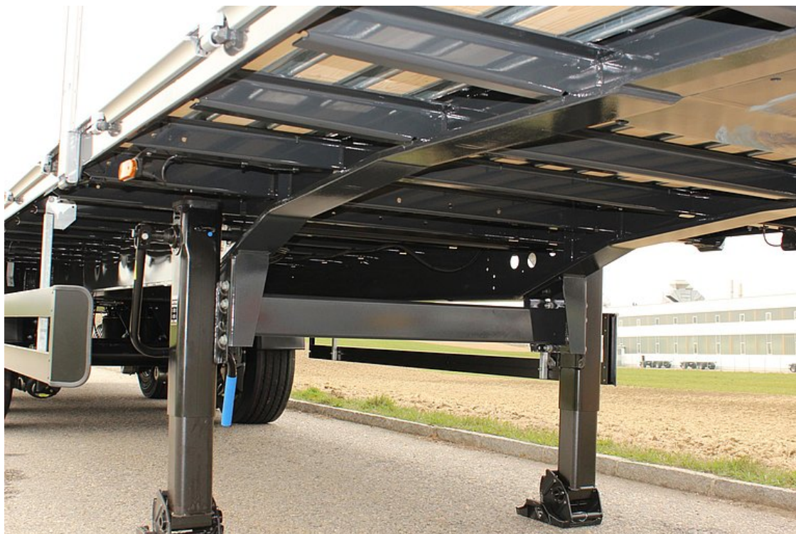
Zesílená konstrukce rámu pro bodové zatížení 20 t na délce 4 m v těžišti vozidla
