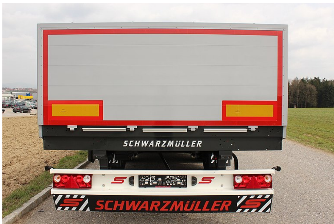
Výklopná zadní stěna z dutých hliníkových profilů, se svislým a vodorovným gumovým těsněním
