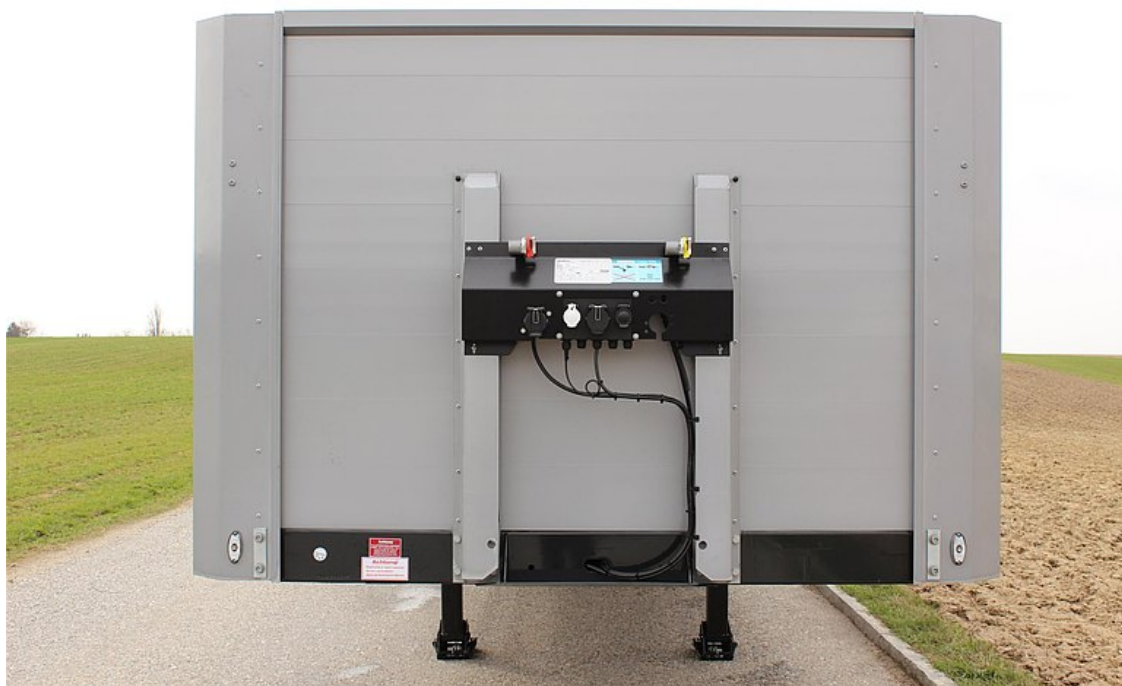
Pevná přední stěna z dutých hliníkových profilů se 2 středovými výztuhami, zevnitř 2 ks vázacích ok pro zajištění nákladu a zesílením z ocelového plechu
