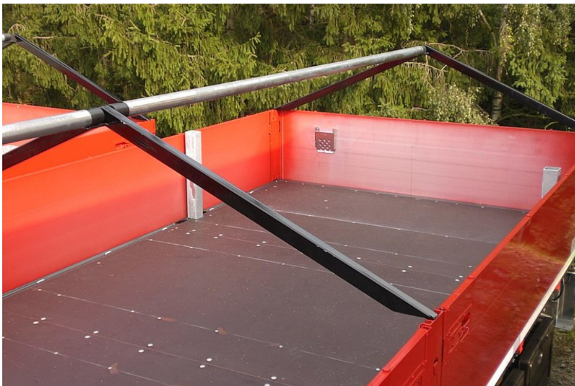
VOLITELNĚ: pevná střeška tvořená 4 střešními oblouky, které jsou přímo nasazeny na středových a zadních sloupcích a podélnou středovou tyčí (sklon střešky 500 mm)
