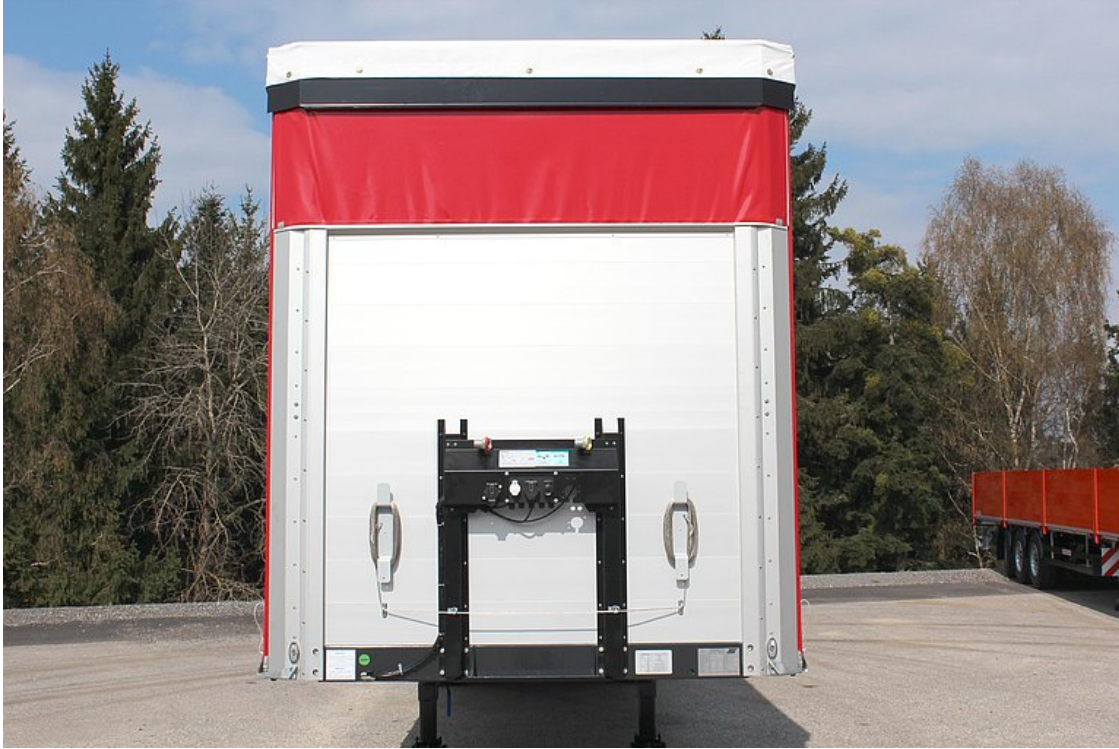
Zesílená přední stěna z hliníkových dutých profilů s integrovaným držákem napájecích přípoju
