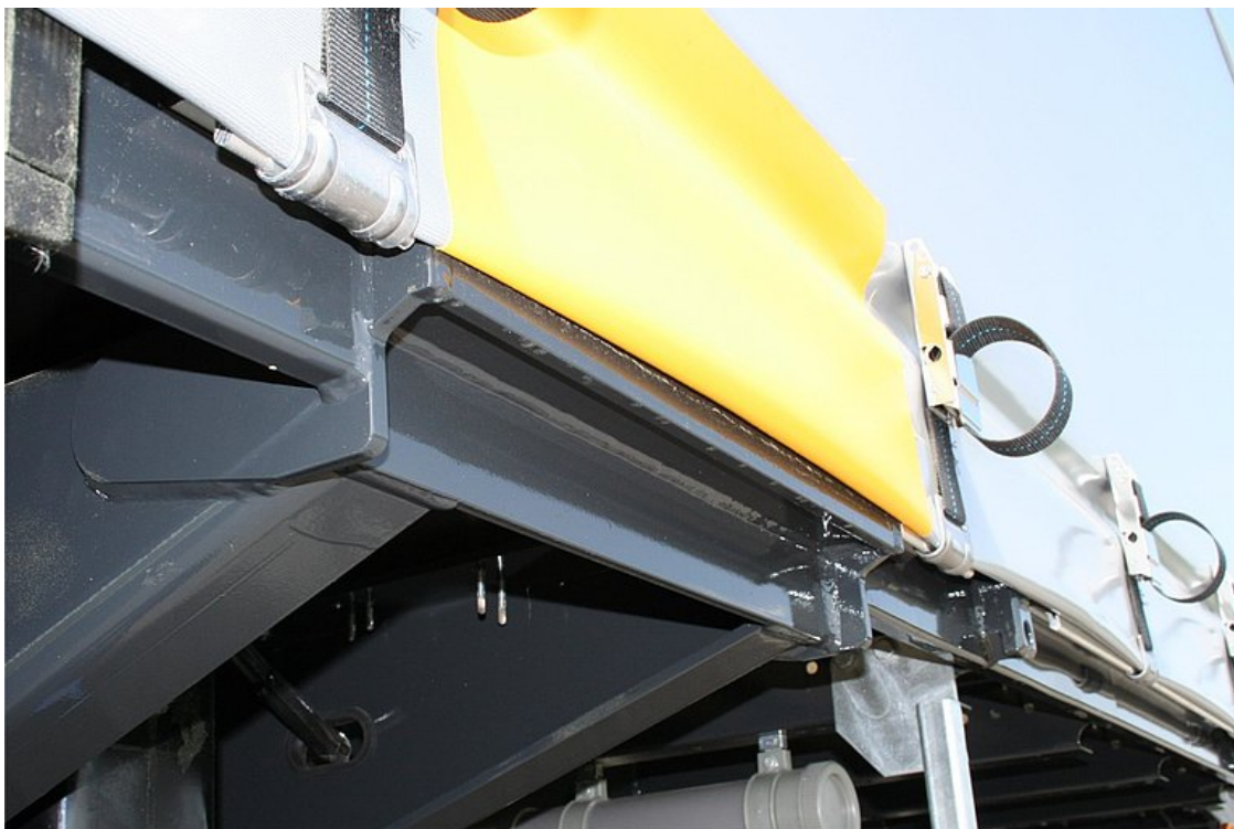
Konstrukce rámu zesílena 4 úchyty za účelem železniční překládky
