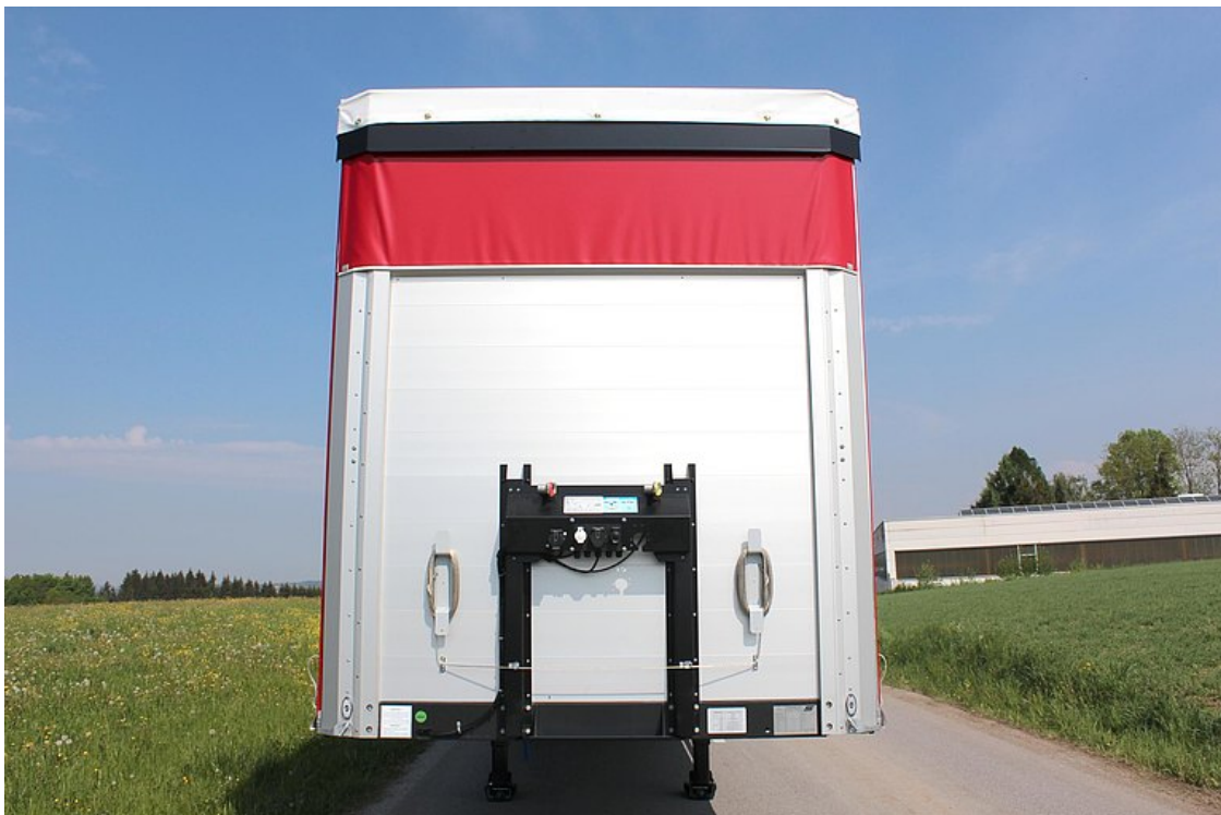
Zesílená přední stěna z hliníkových dutých profilů s integrovaným držákem napájecích přípojků
