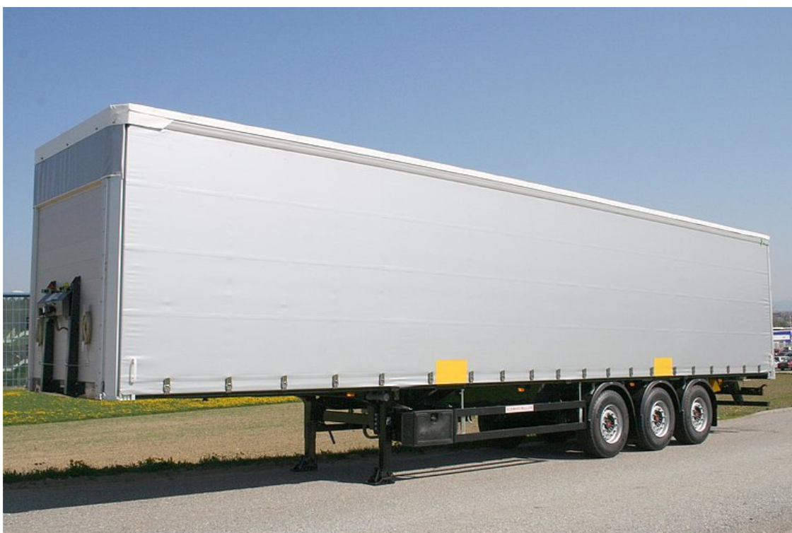
Vysoce kvalitní hliníkové nástavbové komponenty nepodléhající korozi, přezkoušeny dle EN 12642 XL
