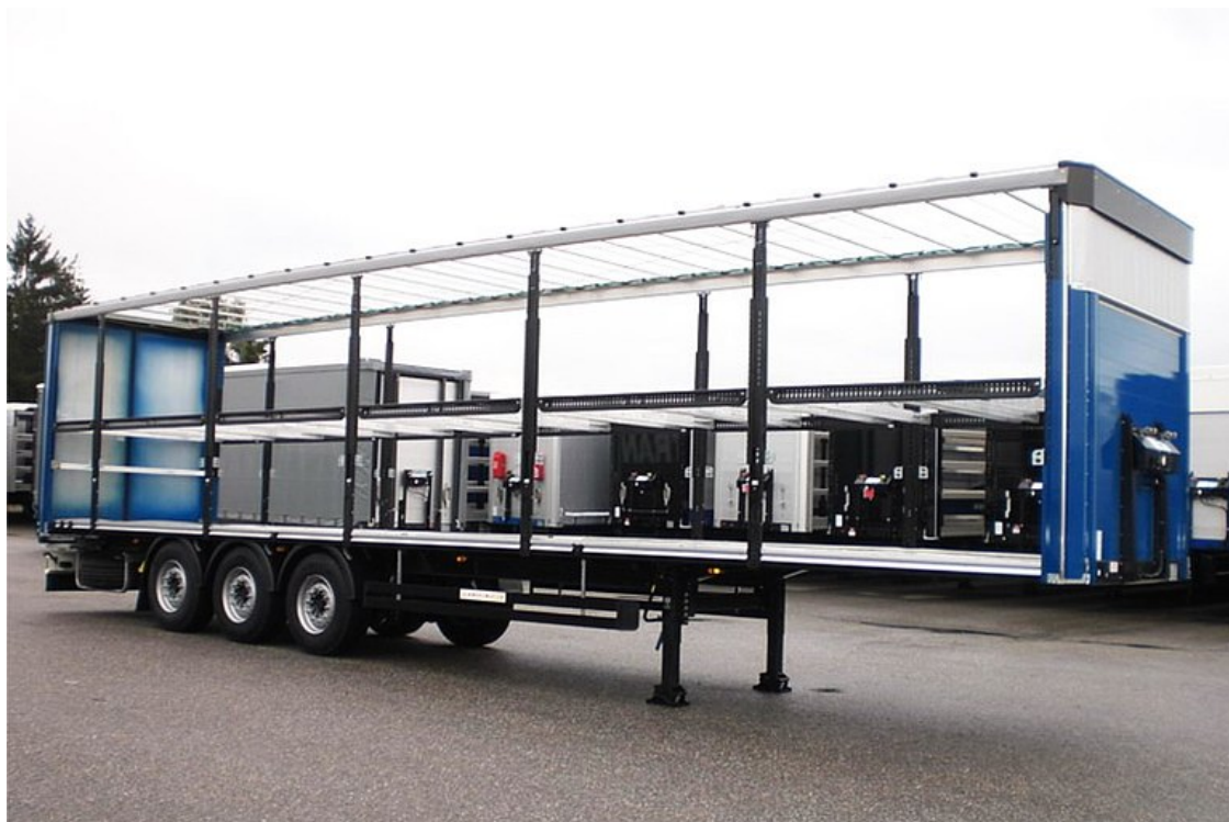
3-nápravový valníkový návěs se stahovatelnou plachtou a systémem dvojité podlahy
