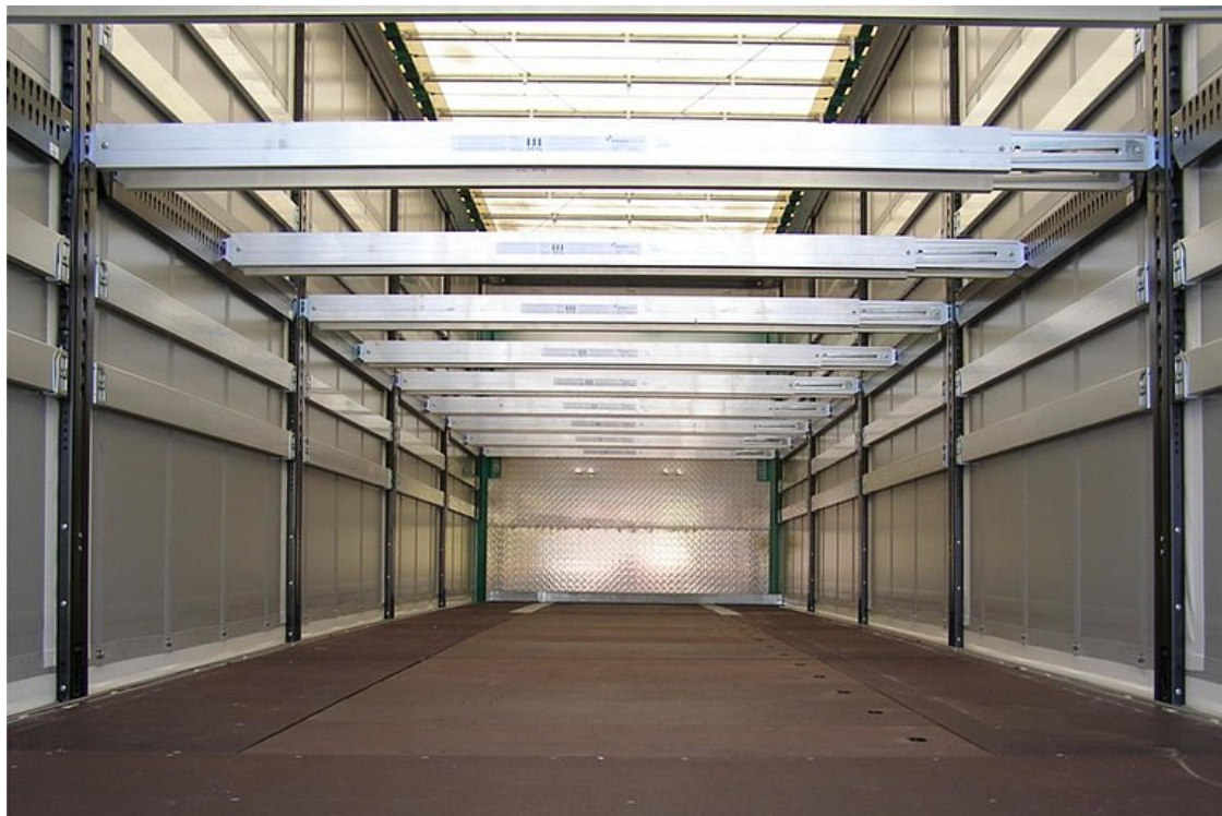
Systém dvojité podlahy CTD III pro 33 europalet na 2. nakládací ploše
