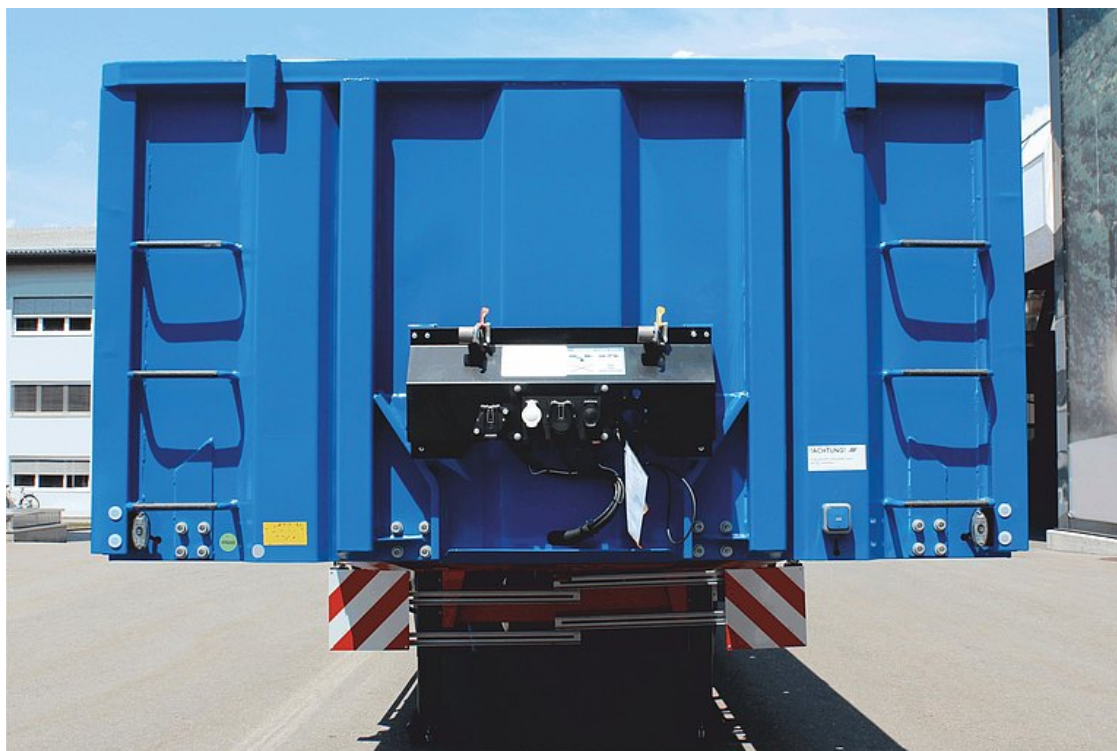
Pevná zesílená přední stěna z dutých hliníkových profilů
