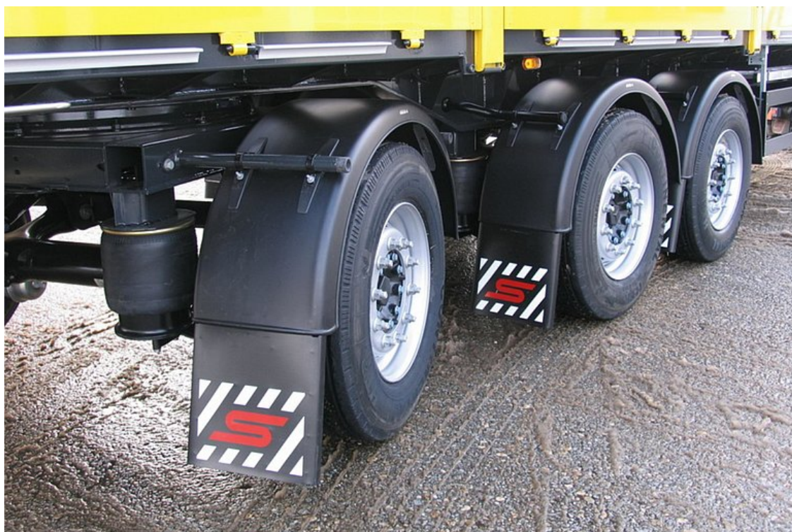
3. náprava návěsu s mechanickým nuceným řízením
