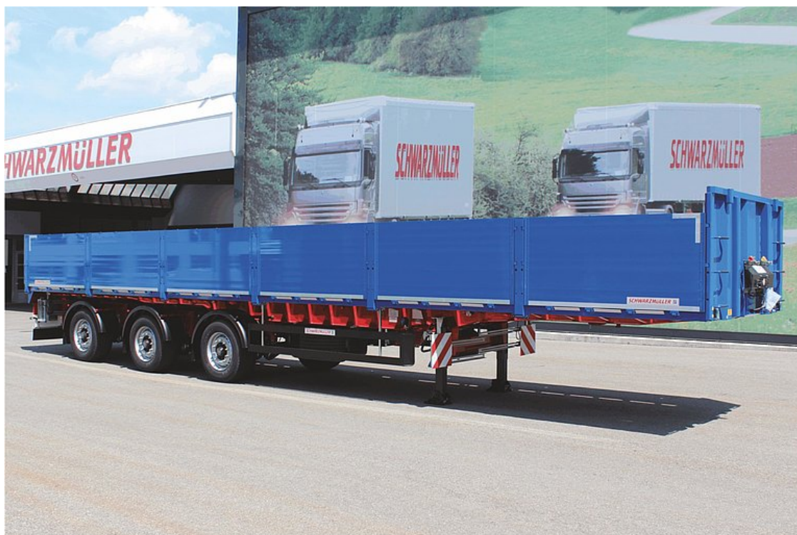
3-nápravový valníkový návěs s kladkovým jeřábem
