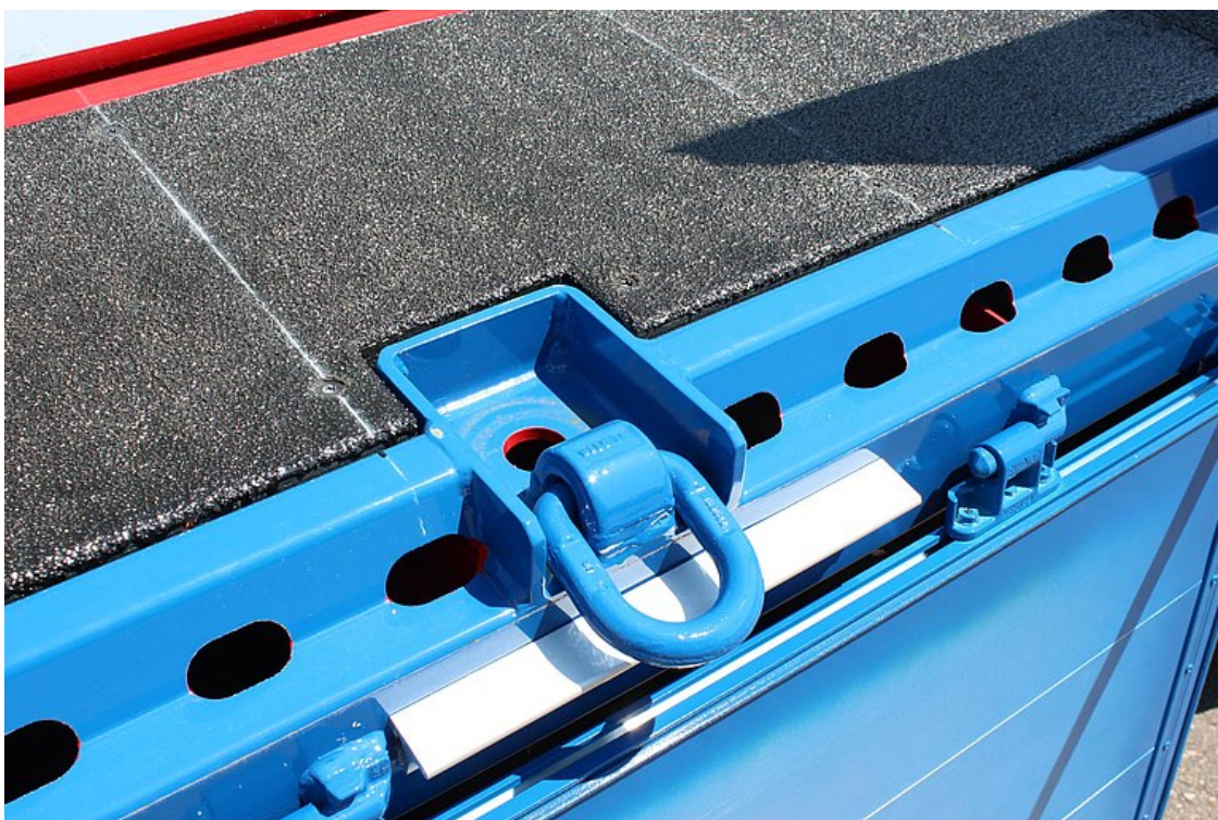
VOLITELNĚ: vysoko výklopná 5 t vázací oka, vestavěná do vnějšího rámu, též výklopná vně
