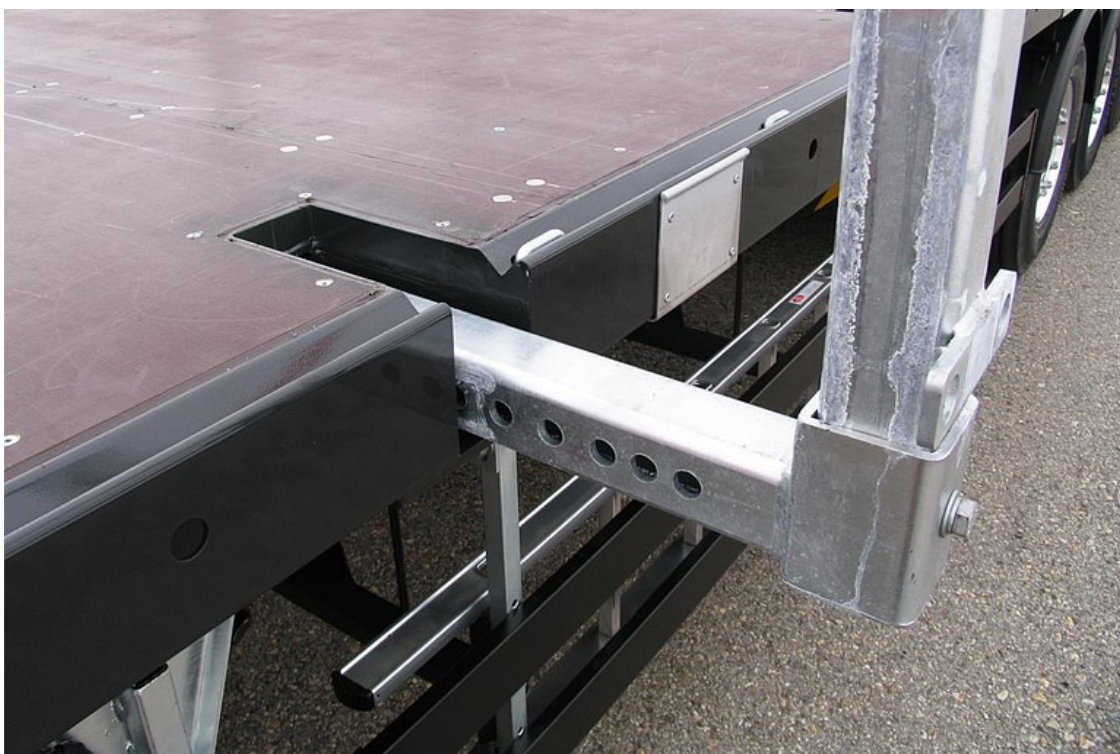
Výsuvná pouzdra pro klanice (odlehčené konstrukce) , nastavitelná pro nakládací šířku od 2.000 mm do 3.100 mm (celkem 13 poloh)
