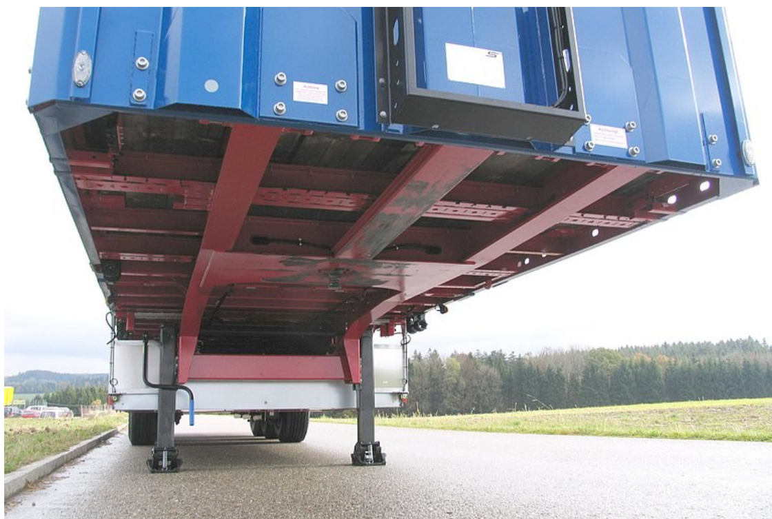
Tuhý žebřinový rám ocelové svařované konstrukce
