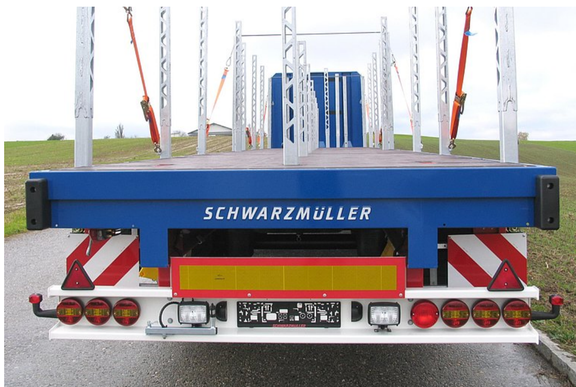
Nárazník s integrovaným systémem koncových světel a gumovými dorazy
