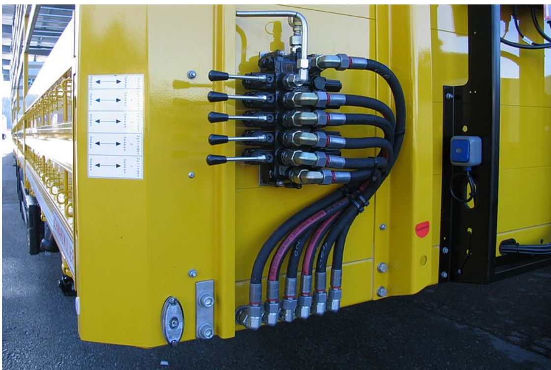
Hydraulicky řídicí jednotka pro systém šikmého uložení nákladu
