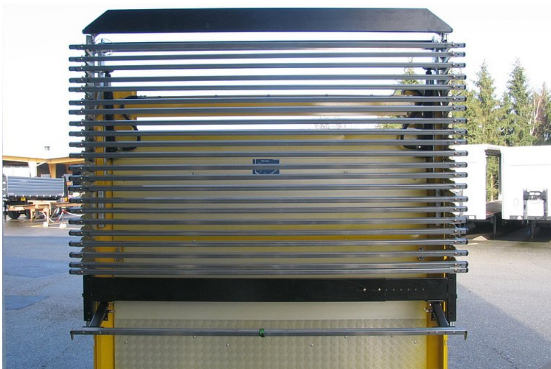
Posuvná střecha na přední stěně zevnitř hydraulicky sklopná - pro nekrytou přepravu plechů
