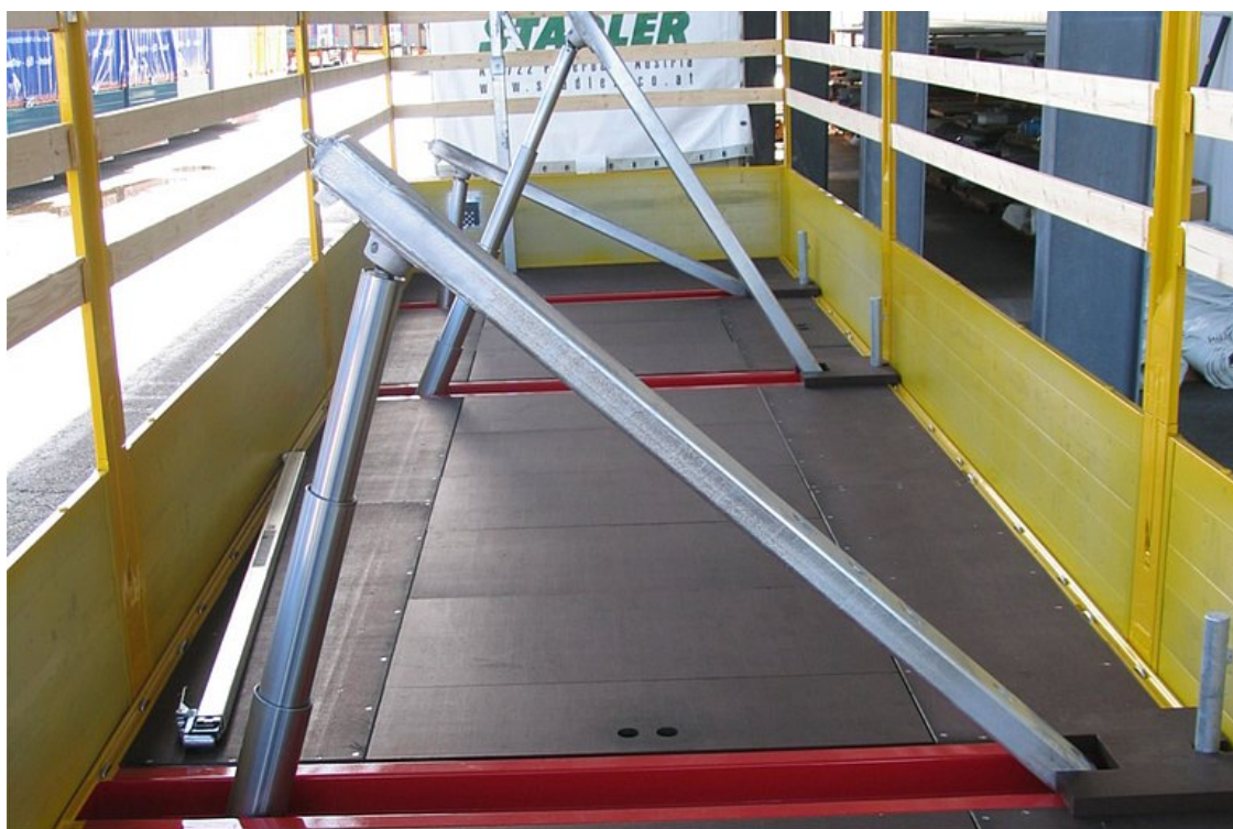
Speciální provedení s hydraulickým šikmým naložením pro přepravu velkoformátových plechů šířky až 3.300 mm
