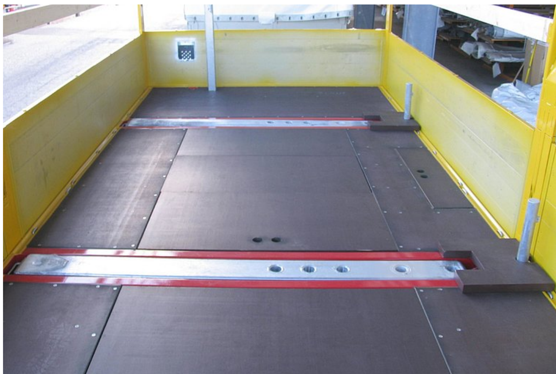
Nakládací plocha se zařízením umožňující šikmé naložení nákladu
