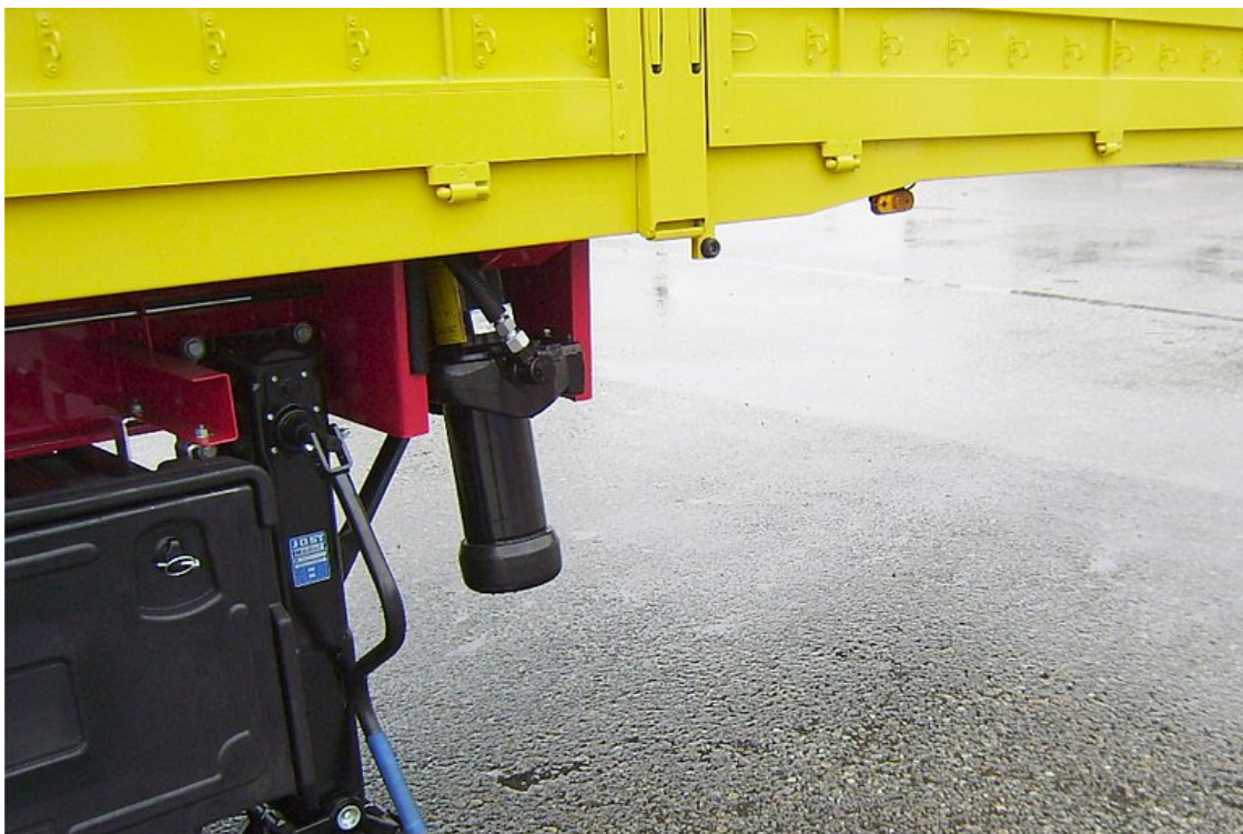
Elektrohydraulický čerpadlový agregát pro samostatné ovládání šikmého uložení nákladu na návěsu
