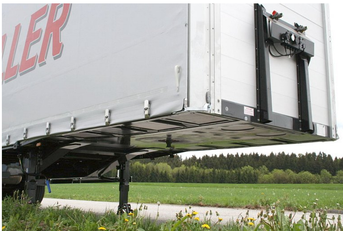
Nízká konstrukce rámu 80 mm pro nízkoložné tahače a pro dosažení vnitřní výšky až 3.000 mm
