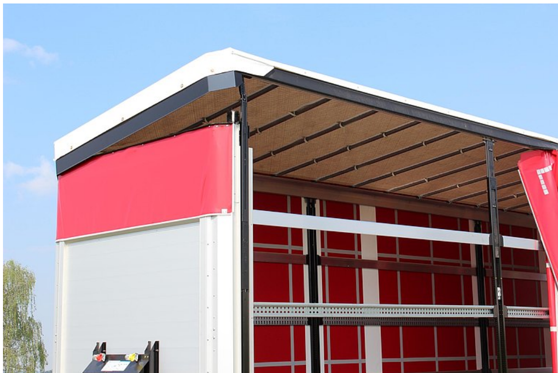
Hydraulický Hubdach s manuálním ovládáním se zdvihem 400 mm, pro rychlou nakládku a vykládku
