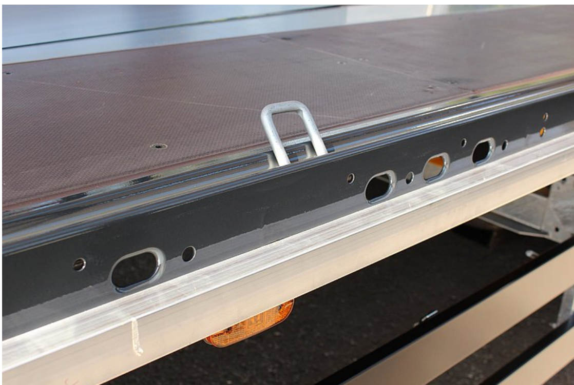
Děrovaný vnější rám (začínající cca 3.000 mm od přední stěny) s rozstupem děr cca 100 mm, podélné díry 40/25 mm dle DIN EN 12640 a 22 párů zapaštěných 2,5 t kotevních třmenů
