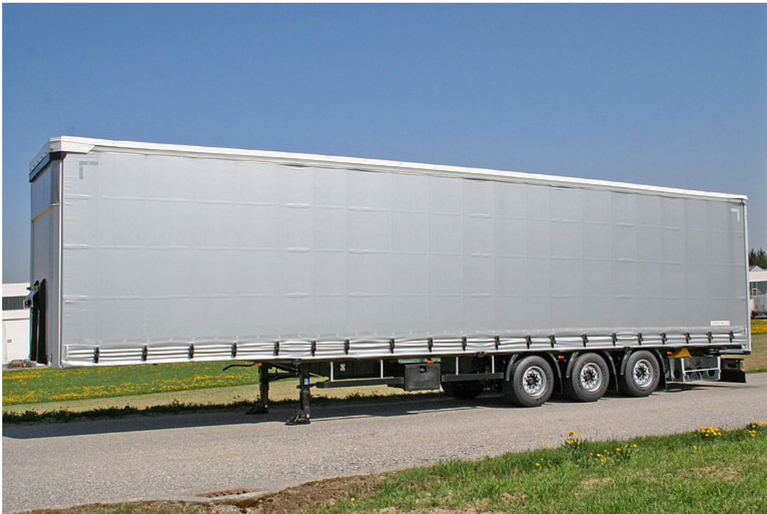
Vysoce kvalitní hliníkové nástavbové komponenty nepodléhající korozi, přezkoušeny dle EN 12642
