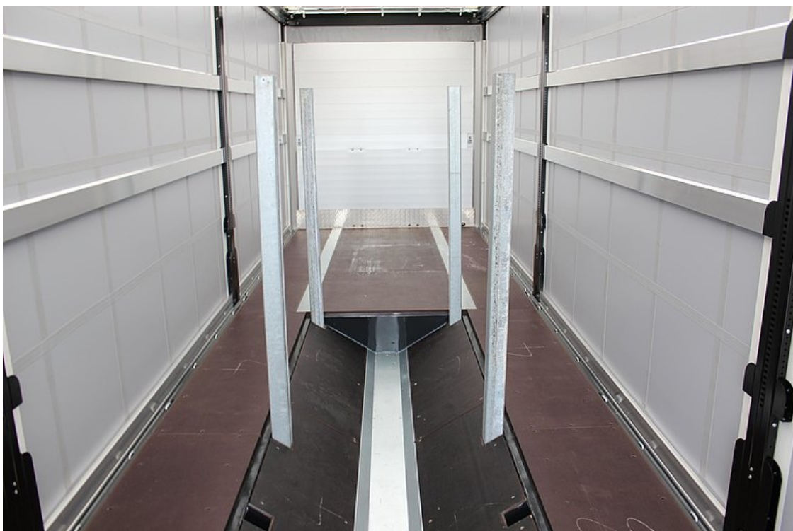
VOLITELNĚ: prohloubené lůžko o užité délce cca 7.400 mm - provedení dle VDI 2 700 pro průměry cívek 900 mm až max. 2.100 mm
