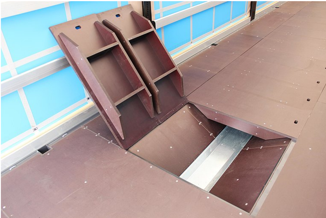
Zakrytí prohloubeného lůžka z tvrzené protiskluzové překližky tl. 27mm, pro přejezd vysokozdvíhým vozíkem
