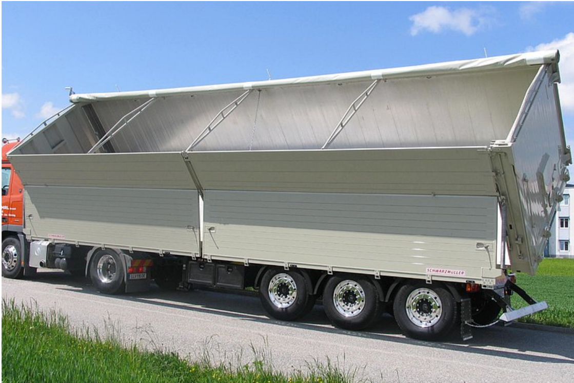
Flexibilní přepravní nasazení díky nakládce a vykládce jakožto i bočnímu sklápění nebo sklápění dozadu
