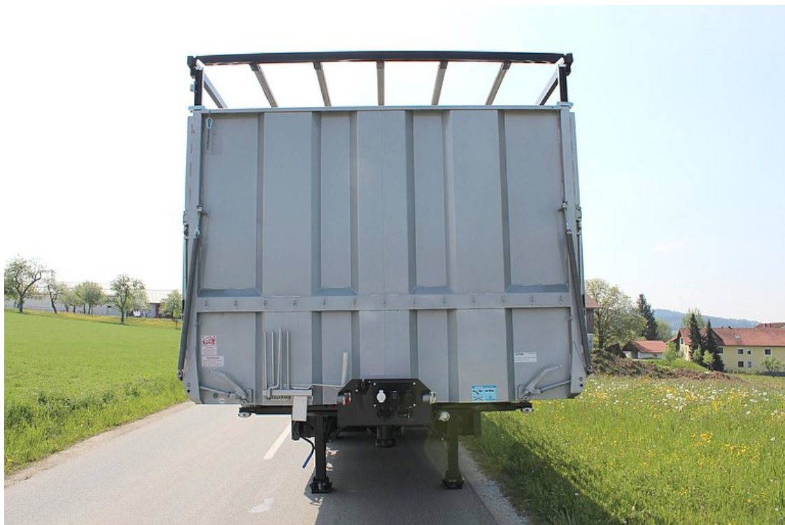
Pevná přední stěna z ocelového plechu tl. 3 mm
