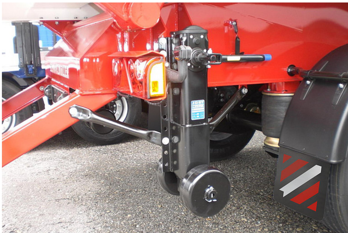
VOLITELNĚ: na konci rámu 2 výsuvné ocelové opěry s koly
