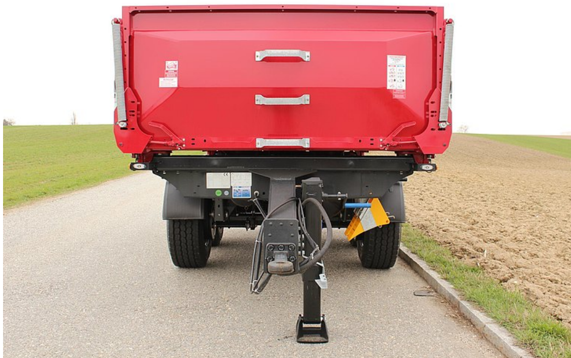
Ocelová přední stěna s výstupky z vnitřní i vnější strany
